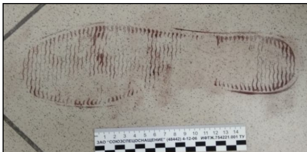
Рис. 16. След подошвенной части обуви, выявленный с помощью дактилоскопического порошка 1
