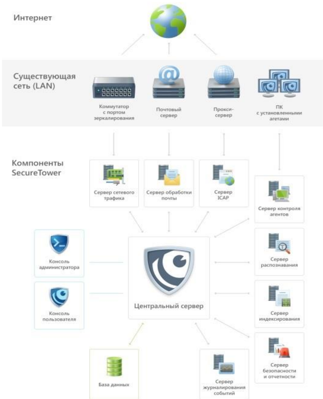
Рис. 9.2. Схема взаимодействия компонентов DLP-системы Falcongaze SecureTower 6.0
