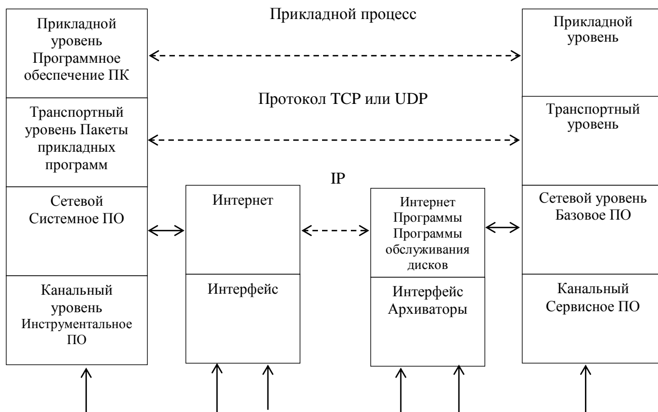
Рис. 6.2. Модель взаимодействия протоколов стека TCP/IP
