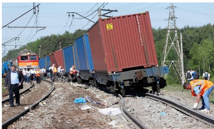
Рис. 14. Сход подвижного состава с рельсов
