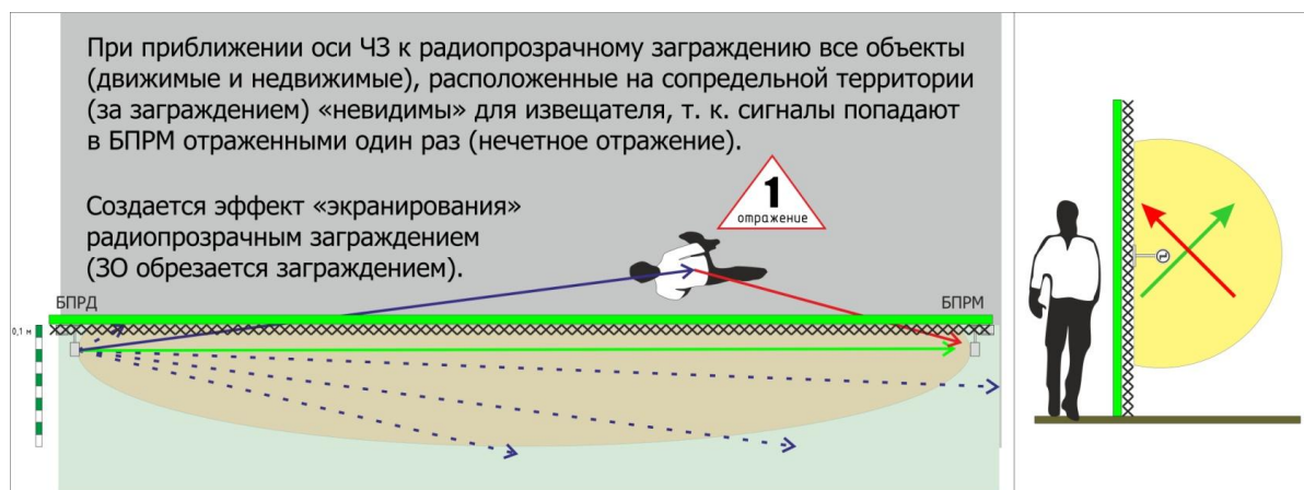
Рис. 2. Эффект экранирования радиопрозрачного ограждения
