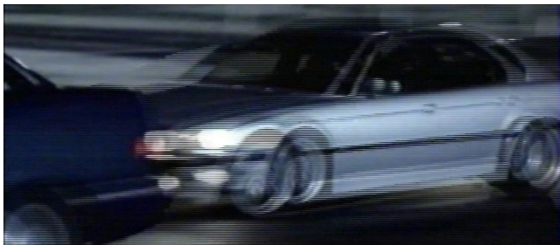
Рис. 5.1. «Гребенка» чересстрочного видео
