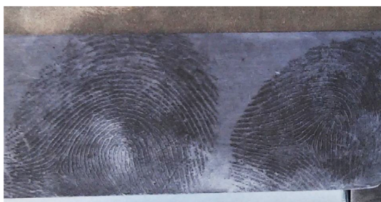
Рис. 7. Следы рук, выявленные на поверхности пистолетного затвора суспензией дактилоскопического порошка «ПД-Ч», покрытого оружейной смазкой и находившегося в снегу при t - 18^{\circ}\text{C} в течение 24 часов
