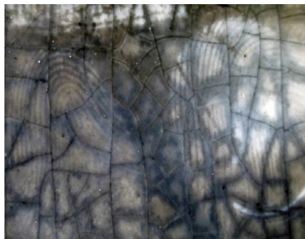
Рис. 8. Следы рук, выявленные раствором нитрата серебра на глазурованной керамической плитке после воздействия температуры до 920°С
