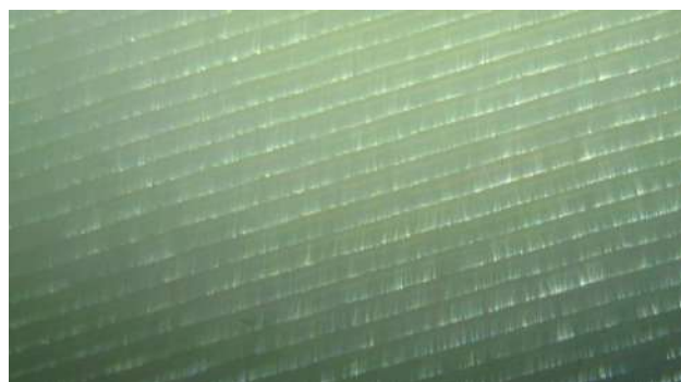
Рис. 2. Изделие из АБС-пластика, изготовленное по технологии FDM – послойного наложения расплавляемых нитевидных полимеров
