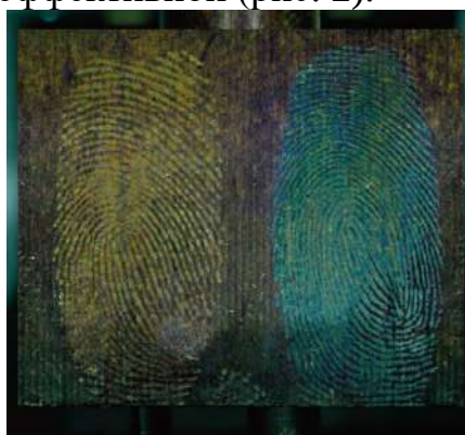
Рис. 2. Изображение папиллярных узоров на гильзе, развернутое с помощью устройства CSU-2 (Cylindrical Surface Unwrapper)
