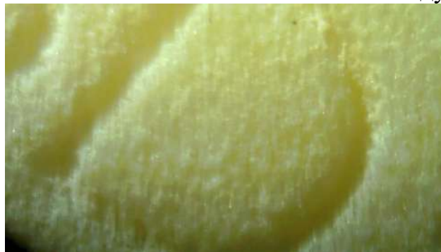
Рис. 1. Изделие из полиамида, изготовленное по технологии SLS – селективного лазерного спекания
