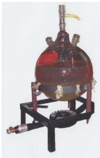
Рис. 1. Самодельный лабораторный реактор на газовой горелке
