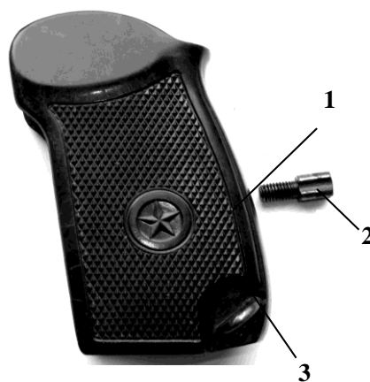
Рис. 42. Рукоятка с винтом: 1 – отверстие для винта; 2 – винт; 3 – антабка
