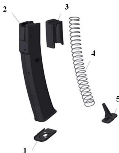
Рис. 77. Магазин пистолета-пулемета «Витязь»: 1 – крышка магазина; 2 – корпус магазина; 3 – подаватель; 4 – пружина; 5 – запорная планка
