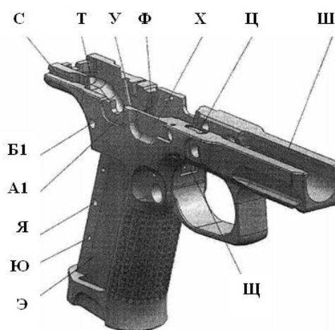
Рис. 62. Вид рамки с правой стороны: С, Ш – направляющие; У, Щ, Ю, Я, Б1 – отверстия; Т, Ф, Х, Ц – пазы; Э – шахта магазина.
