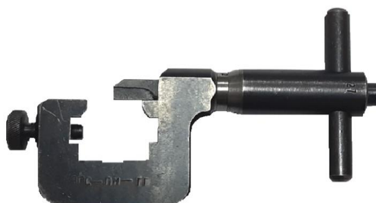
Рис. 57. Прибор регулировки боя для пистолетов АПС, ПМ, ТТ
