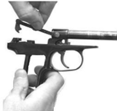
Рис. 49. Полная разборка: отделить спусковую тягу с рычагом взвода
