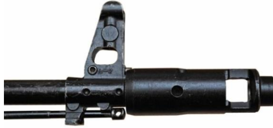
Рис. 91. Дульный тормоз-компенсатор автомата АК74
