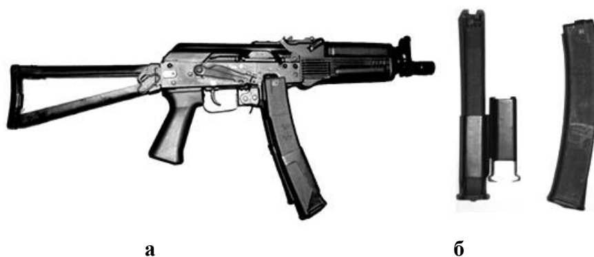
Рис. 67. а – 9-мм пистолет-пулемет «Витязь» ПП-19-01. Сб-10; б – специальная скоба для парного скрепления магазинов
