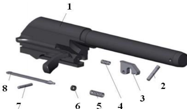
Рис. 71. Затвор пистолета-пулемета «Витязь»: 1 – основание затвора; 2 – ось выбрасывателя; 3 – выбрасыватель; 4 – пружина выбрасывателя; 5 – пружина ударника; 6 – втулка; 7 – штифт ударника; 8 – ударник
