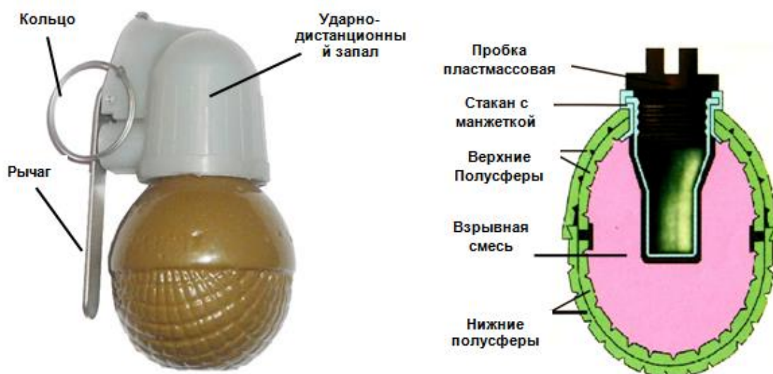
Рис. 135. Устройство ручной осколочной гранаты РГО
