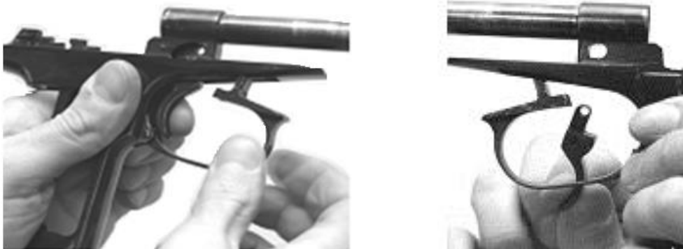
Рис. 50. Полная разборка: оттянуть спусковую скобу вниз и слегка влево или вправо, упереть в рамку; отделить спусковой крючок
