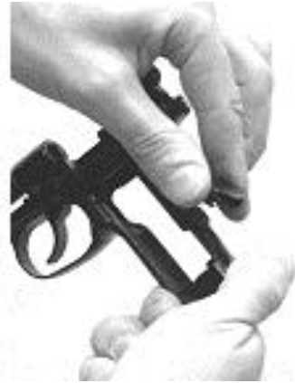
Рис. 47. Полная разборка: отделить рукоятку от основания рукоятки и боевую пружину от рамки
