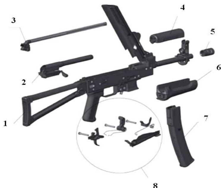
Рис. 69. Основные механизмы и детали пистолета-пулемета ПП-19-01 «Витязь»: 1 – ствол со ствольной коробкой, прикладом и крышкой ствольной коробки; 2 – затвор; 3 – возвратный механизм; 4 – ствольная накладдка; 5 – дульный тормоз; 6 – цевье; 7 – магазин; 8 – ударно-спусковой механизм
