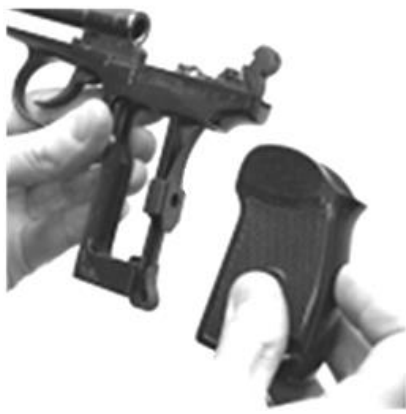
Рис. 47. Полная разборка: отделить рукоятку от основания рукоятки и боевую пружину от рамки
