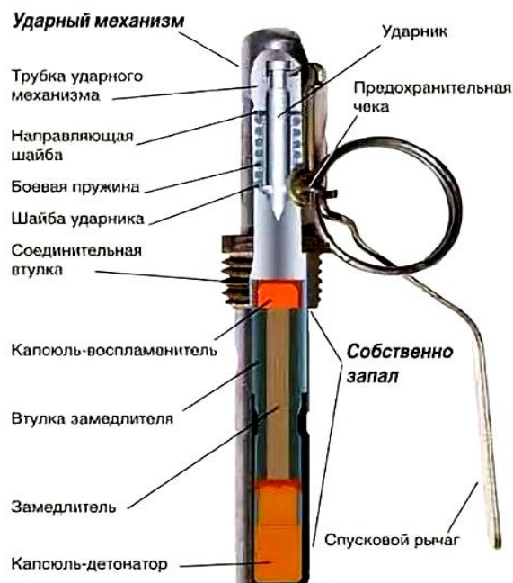
Рис.132. Устройство запала УЗРГМ ручной осколочной гранаты РГД-5
