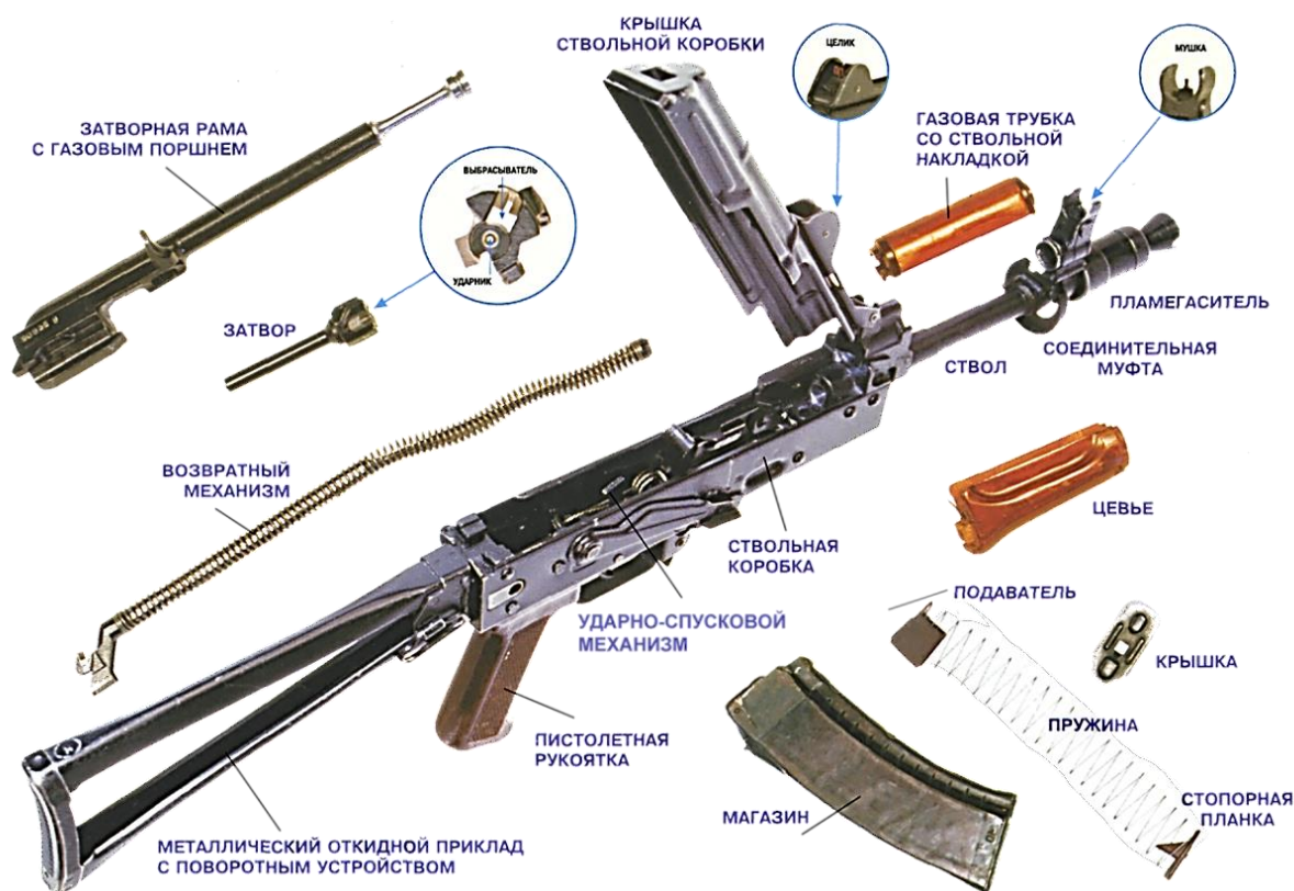
Рис. 89. Общее устройство 5.45-мм автомата Калашникова АКС-74У
