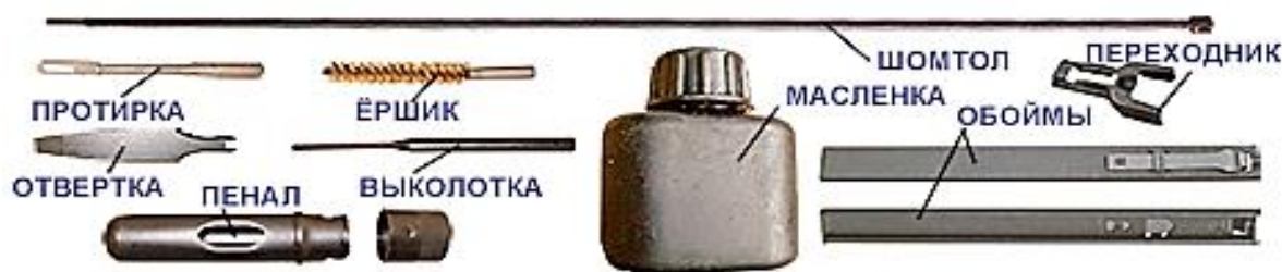
Рис. 88. Комплект 5.45-мм автомата Калашникова АК-74М
