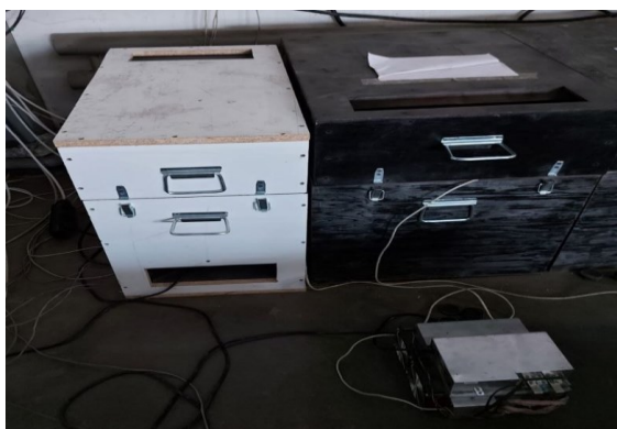
Фото 1. Шумобокс на 2 (слева) и 3 (справа) устройства для майнинга криптовалюты
