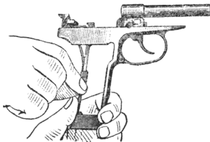
Рис. 31. Закрепление боевой пружины задвижкой
