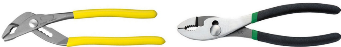
Рис. 17.3. Плоскогубцы: регулируемые (слева) и переставные (справа)
