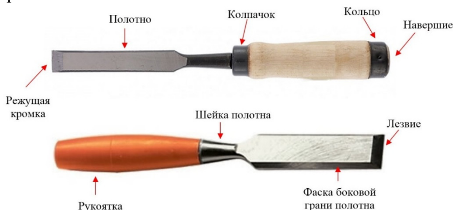
Рис. 2.2. Устройство долота (вверху) и стамески (внизу)
