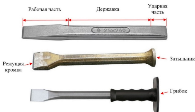
Рис. 3.7. Устройство слесарных зубил разной конструкции
