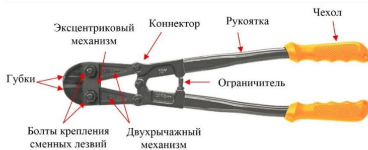
Рис. 14.4. Внешний вид и устройство арматурных ножниц
