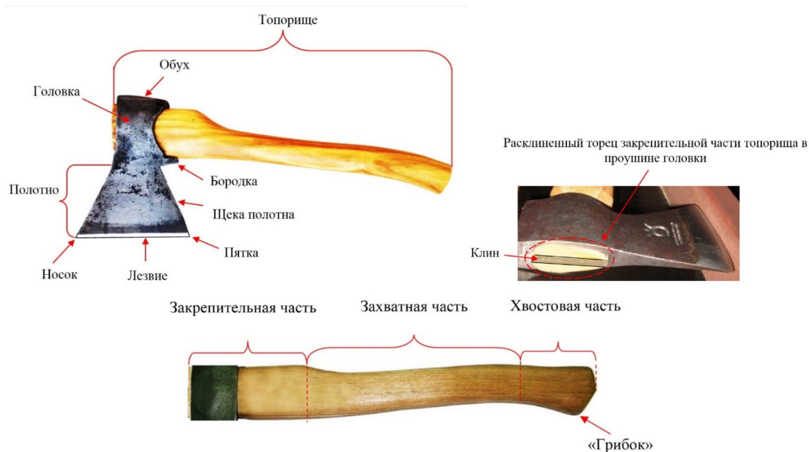
Рис. 18.15. Внешний вид и устройство топора
