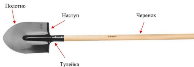
Рис. 10.3. Внешний вид и устройство копальной остроконечной лопаты
