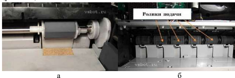
Рис. 123. Комплекс роликов в струйном принтере: а – ролики захвата; б – ролики подачи бумаги
