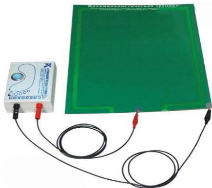
Фото № 7. Прибор для изъятия пылевых следов.
