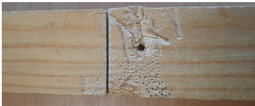
Фото № 17. След резания (распила, сверления).
