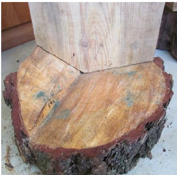
Ил. 28. Полное совмещение спиля с пня № 1 и фрагмента доски (спил № 3)
