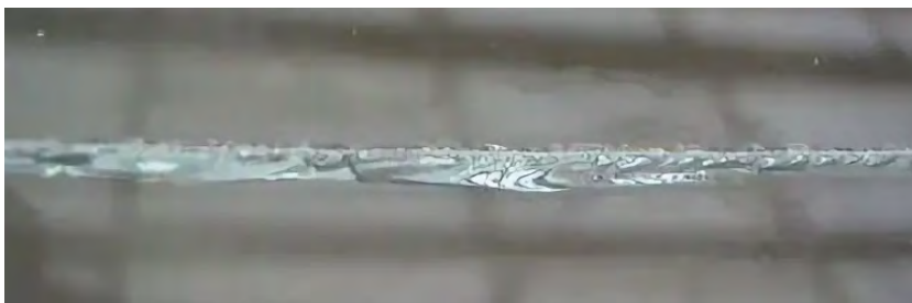
Рис. 14. Следы на изделиях из стекла от режущего инструмента
