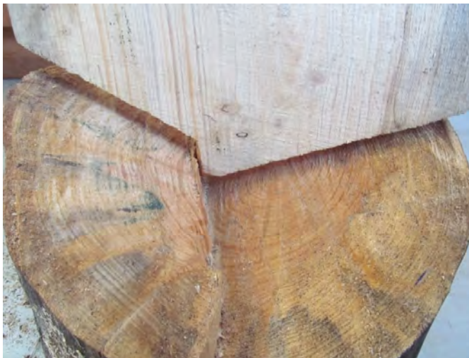
Ил. 29. Неполное совмещение спилов с пня № 2 и фрагмента доски (спил № 4)
