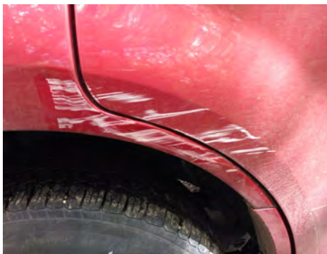
Рис. 8. Динамические следы скольжения на крыле и двери автомобиля
