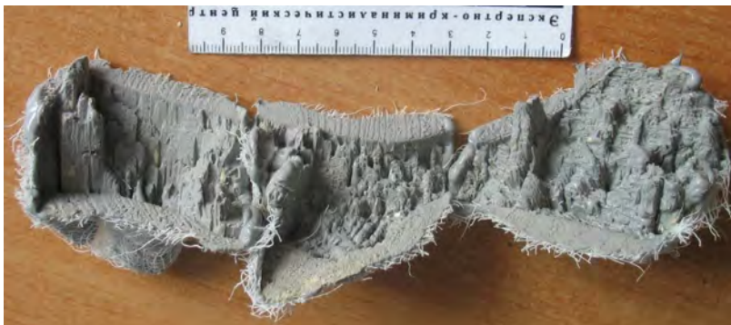
Фото 27. Вид со стороны перекопированных следов разделения (разлома) древесины на слепки с представленных трех фрагментов древесины (расположены в порядке «3»–«2»–«1»)
