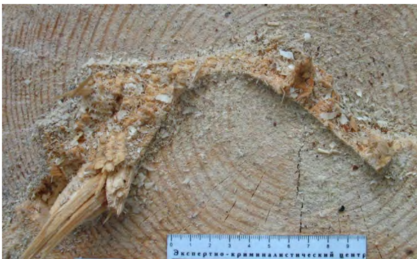
Фото 10. Вид на следы разделения волокон массива древесины ствола дерева в центральной части представленного спила «с пня дерева» (область, указанная на фото 5)
