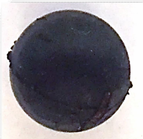
Рис. 18. Отстреленная пуля со следами деформации патрона 12 калибра травматического действия
