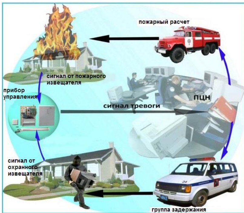
Рисунок 1.4. Пример схемы охранно-пожарной сигнализации централизованного типа
