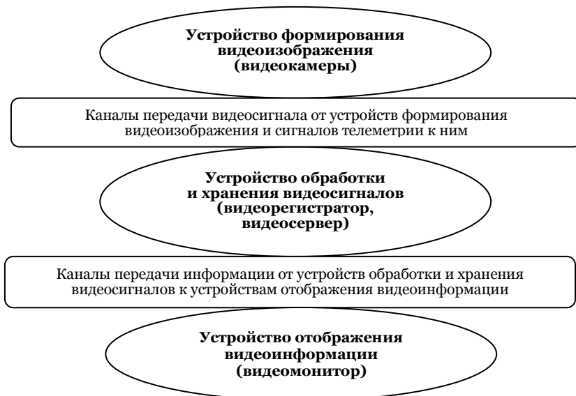
Рисунок 2.1. Обобщенная структурная схема СОТ
