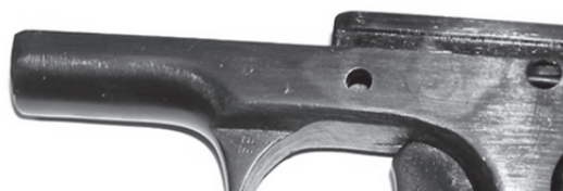
Рис. 7. Направляющие выступы на рамке пистолета 2
