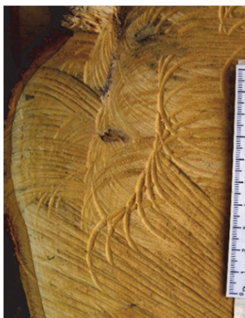
Рис. 5. Следы пиления при перемене общего направления движения шины пилы
