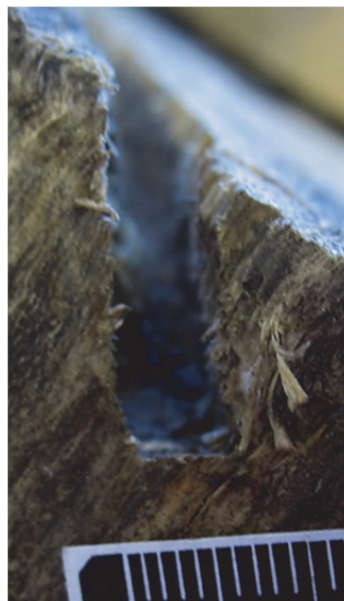
Рис. 3, 4. Профиль следа неполного распила
