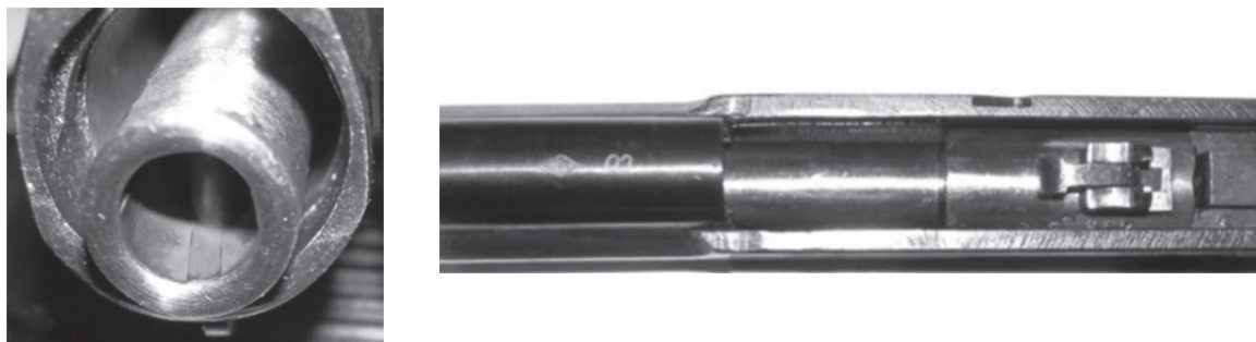
Рис. 6. Вид ствола с дульной части и отсутствие боевых упоров на стволе 1
