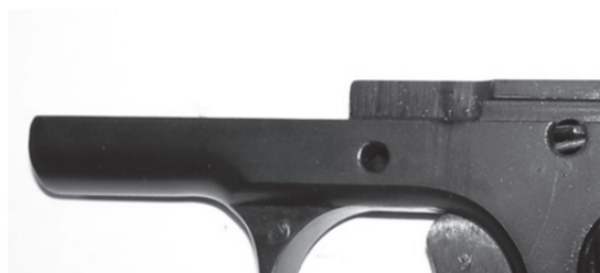
Рис. 2. Фрезеровка направляющих выступов на рамке pistols 2
