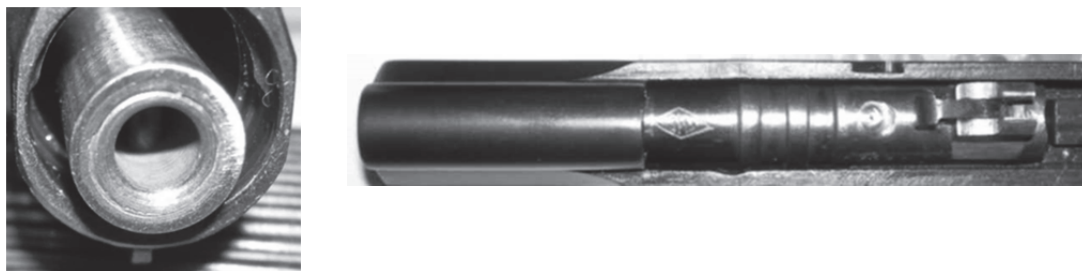
Рис. 1. Вид ствола с дульной части и вид боевых упоров на стволе 1
