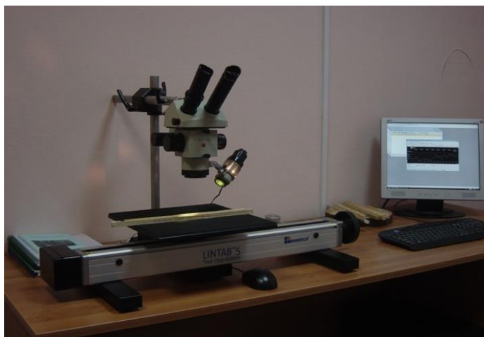
Рисунок 3. Прибор для измерения годичных колец LINTAB фирмы RINNTech (фото с официального сайта компании «ЗДОРОВЫЙ ЛЕС» г. Москва)
