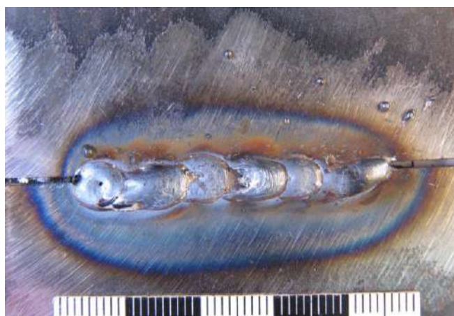
Рис. 2. Сварочный шов, выполненный в среде защитного газа CO_2 , с предварительной зачисткой поверхностей (направление сварки справа налево)
