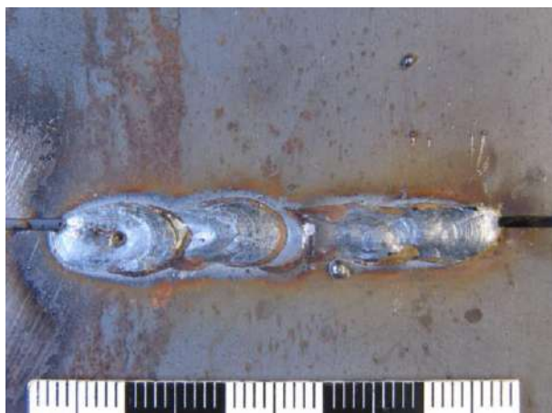
Рис. 1. Сварочный шов, выполненный в среде защитного газа CO_2 , без предварительной зачистки поверхностей (направление сварки справа налево)
