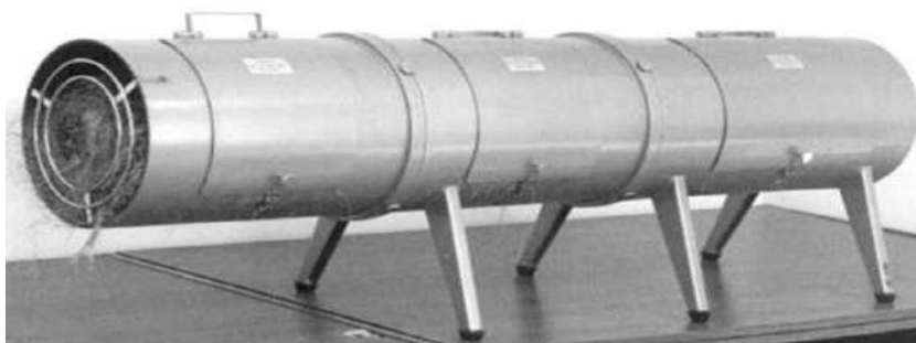
Рисунок 2. Пулеулавливатель «ПУ-1 МУ» (с кевларовым наполнителем)
