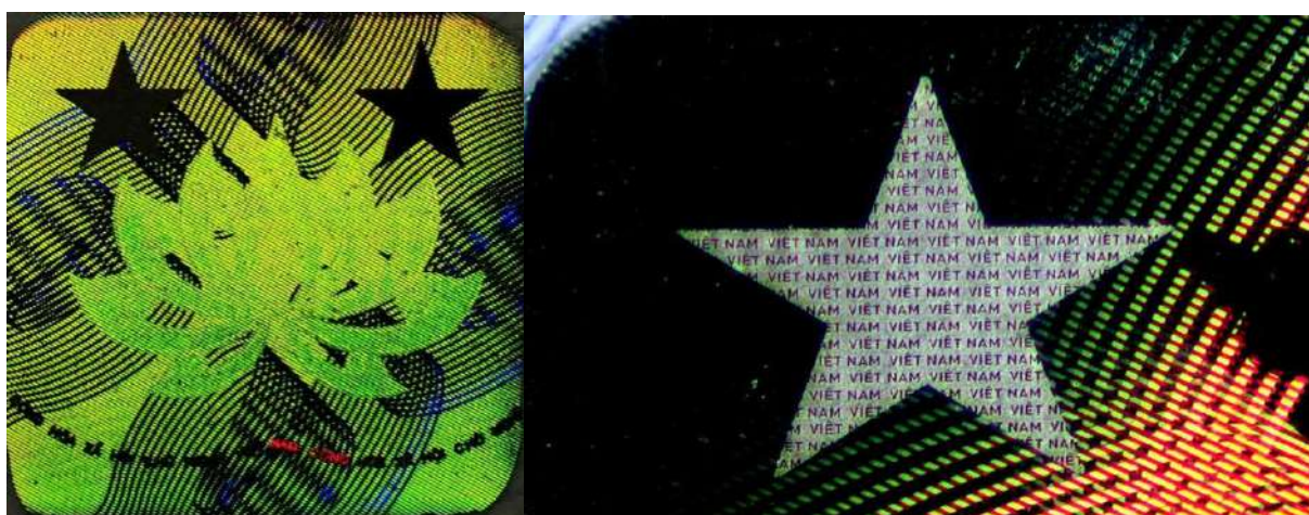
Рис. 2. Люминесцентная голограмма и элемент микропечати на обратной стороне удостоверения личности при OVD лучах
