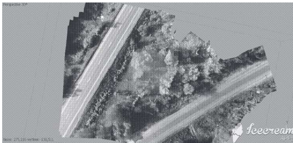
Рис. 3. Фотоплан, созданный на основе снимков БПЛА (для изображения было важно воссоздать план местности, а не зафиксировать обстановку места происшествия, в связи с чем, автомобили были удалены)
