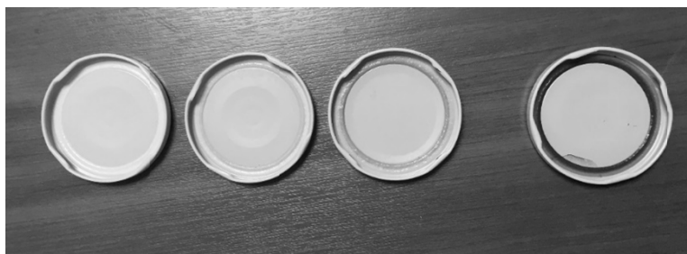
Рисунок 1 – Химическая эрозия уплотнительного кольца
