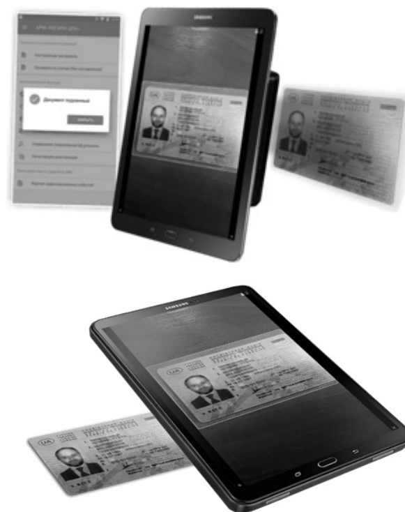
Рисунок 2. Распознавание типа документа и проверка на подлинность при помощи мобильного аутентификатора документов «Регула», модель 1120
