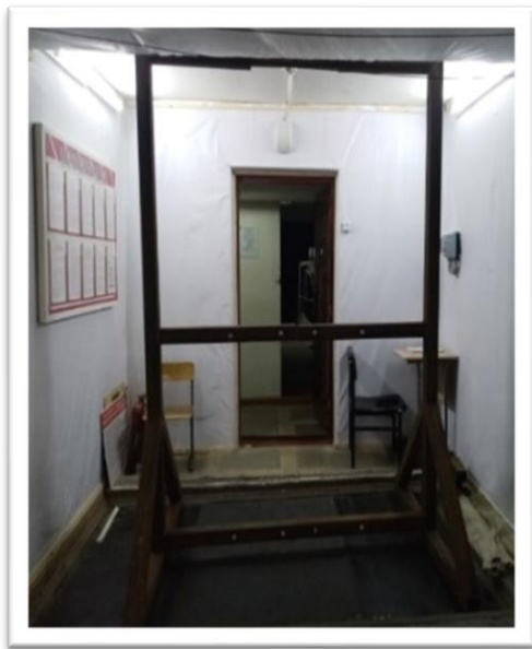
Рис. 21. Основание разборного стенда
