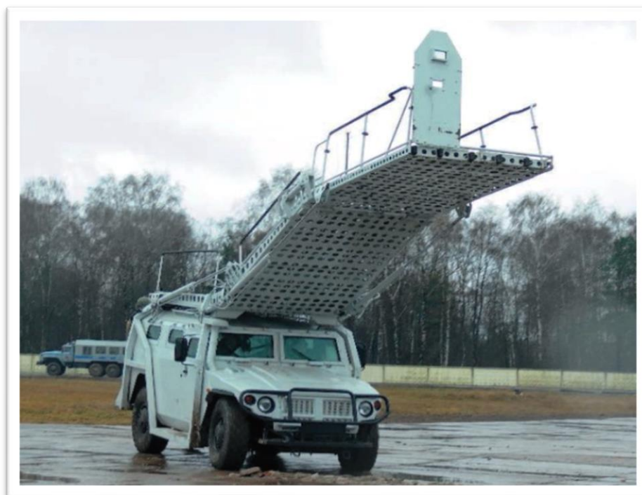
Рис. 34. Трап раздвижной гидравлический со штурмовым щитом на базе автомобиля СПМ «Тигр»
