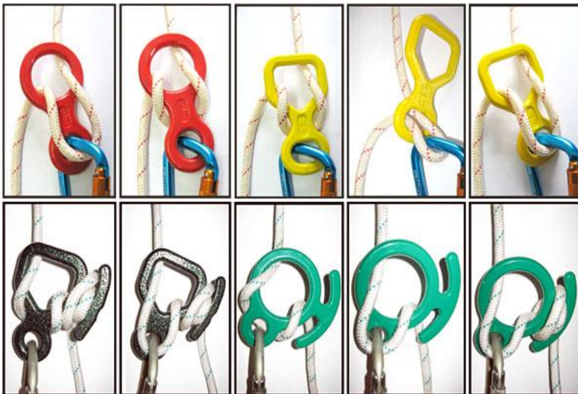
Рис. 3. Спусковое устройство типа «Восьмерка»
