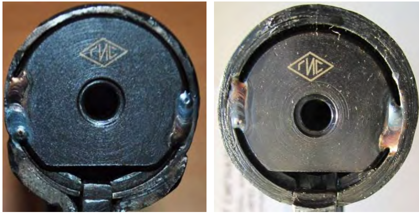
Рис. 6, 7. Казенная часть ствола со вставленной втулкой сигнального пистолета «ВПО-524-1» после внесенных заводских изменений
