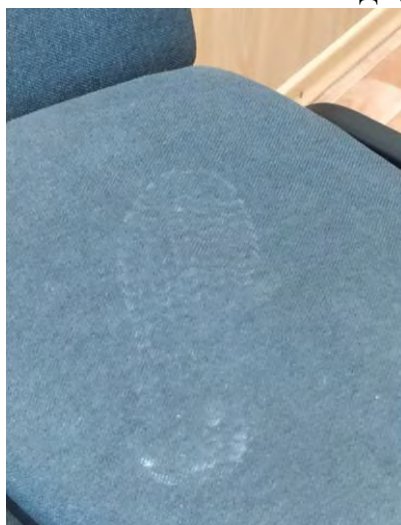
Рис. 2. Экспериментальный след подошвы ботинка, образованный на сиденье стула
