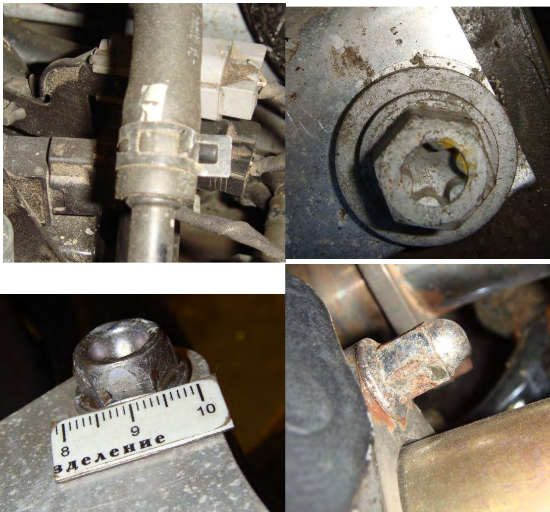
Рис. 3–6. Трасологические признаки снятия (перестановки) узлов и агрегатов ТС
