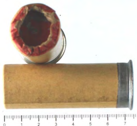
Рис. 2. Патроны 4-го калибра (26 мм), являющиеся штатными для ОСП-30
