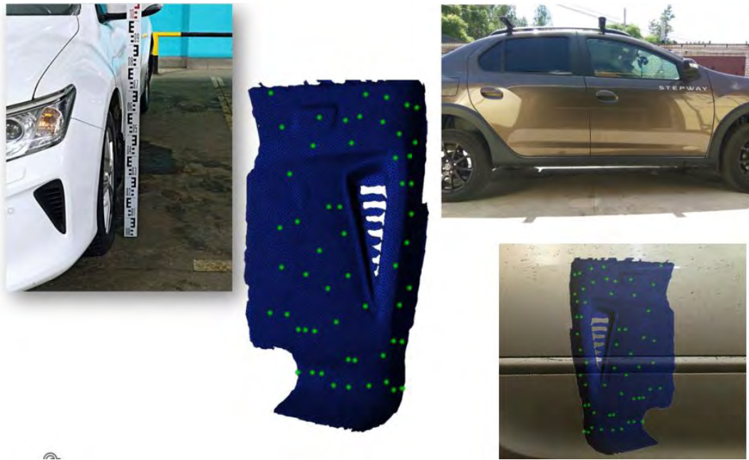
Рис. 9. 3D-сканирование как способ моделирования (сопоставления) частей исследуемых автомобилей
