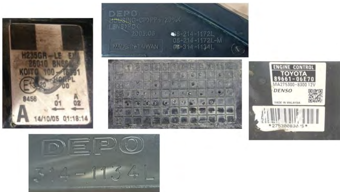
Рис. 6. Особенности структуры маркирования частей автомобиля «Тойота-Камри»
