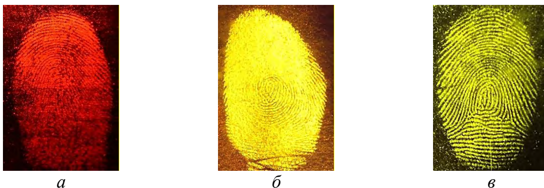
Рис. 5. Применение флуоресцентных немагнитных порошков на шероховатой поверхности : а – Pink-escent ; б – Yellow-escent ; в – Regular Yellow
