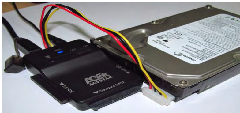
Рис. 4. HDD – USB-адаптер, разработанный в компании AgeStar INC
