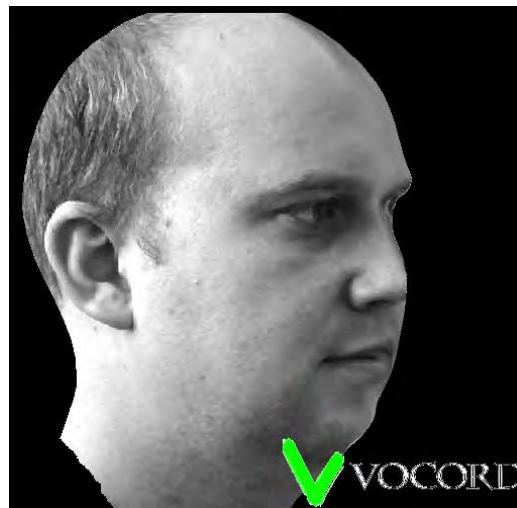
Рис. 6. 3D-модель лица, созданная алгоритмом Vocord из нескольких 2D-фотоизображений
