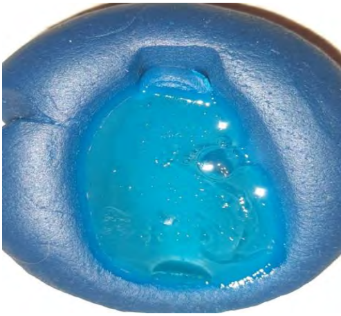
Рис. 2. Использование желатина для создания объемного аналога папиллярного узора пальца руки
