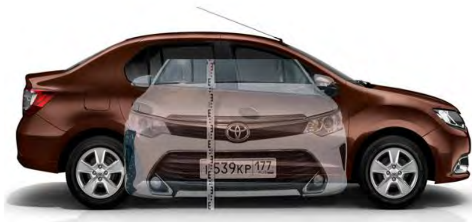
Рис. 3. Фотографическое моделирование локализаций следов от выступающих частей автомобилей
