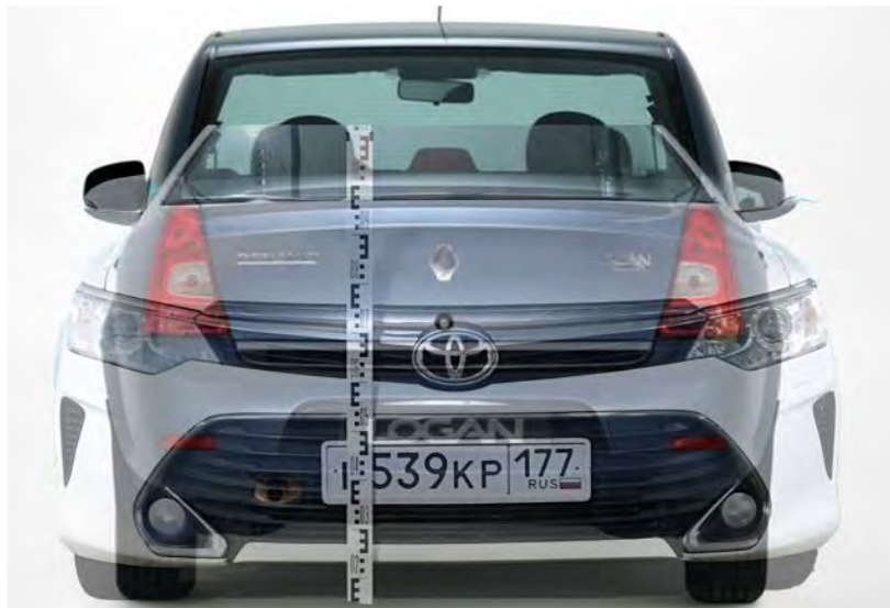
Рис. 5. Фотографическое моделирование локализаций следов от выступающих частей автомобилей
