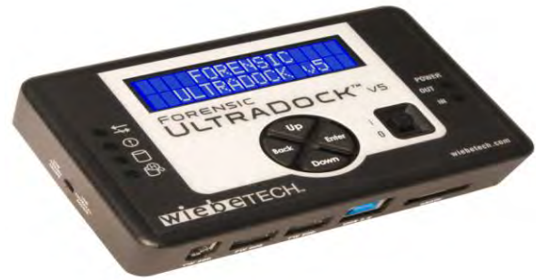
Рис. 1. Аппаратные блокираторы записи: а – Tableau; б – Wiebitech Forensic UltraDock v5
