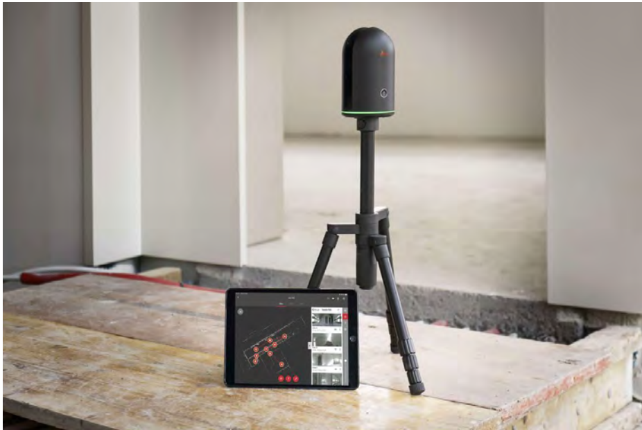
Рис. 1. 3D-сканер Leica BLK360 с полем зрения 360°
