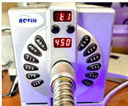
Рис. 1. Источник экспертного света Polilight PL500 от фирмы Rofin
