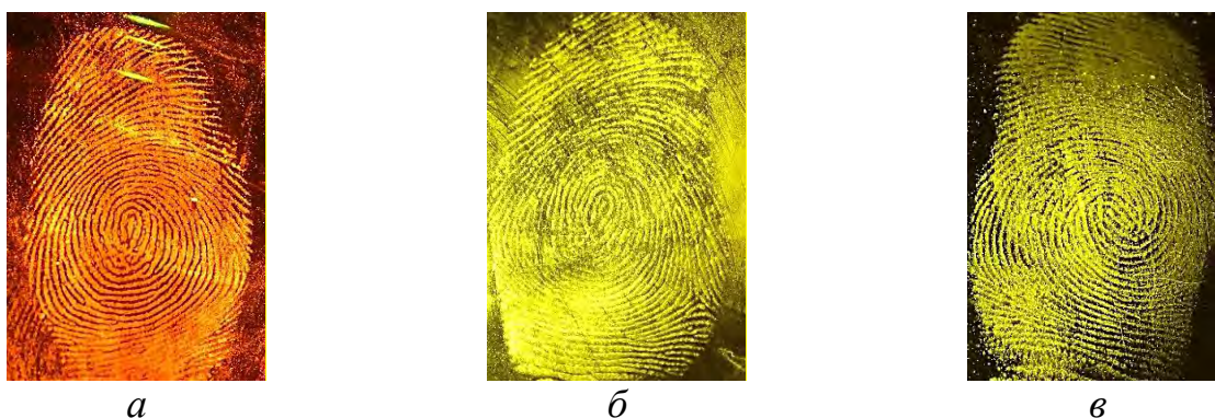
Рис. 6. Применение флуоресцентных немагнитных порошков на стеклянной поверхности : а – Pink-escent ; б – Yellow-escent ; в – Regular Yellow
