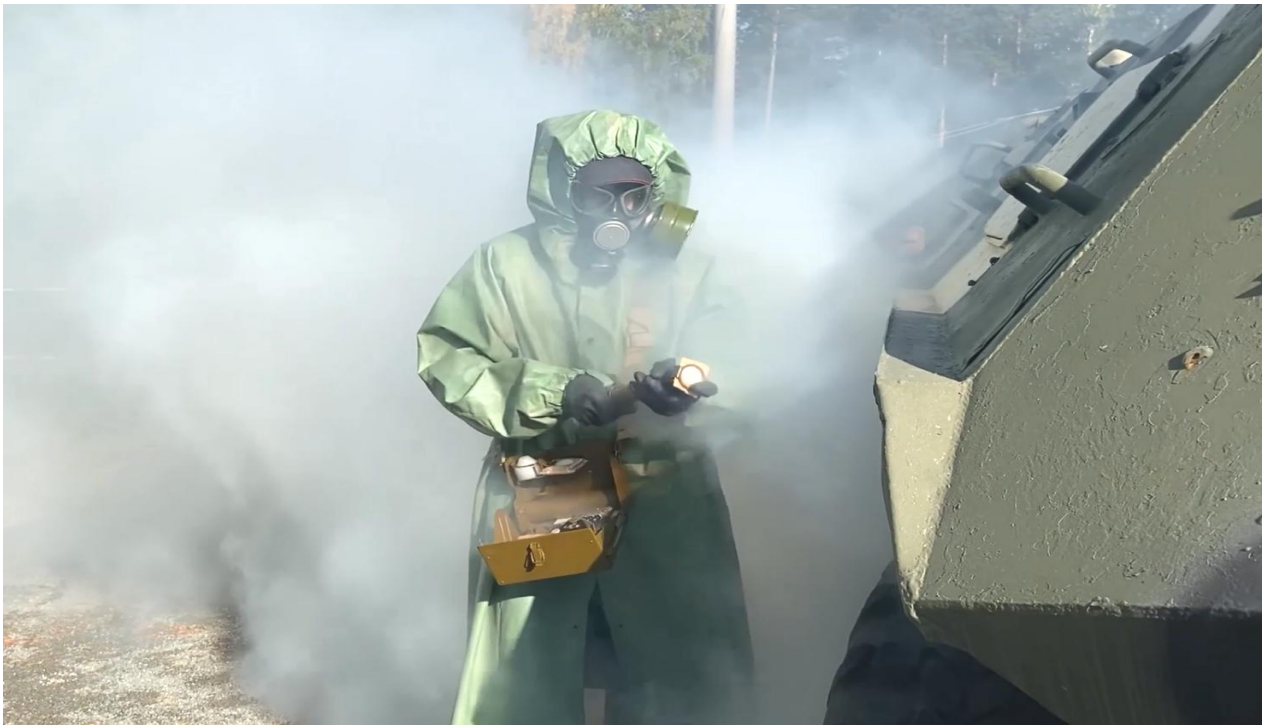
Рис. 17. Использование ВПХР для определения отравляющих веществ в дыму
