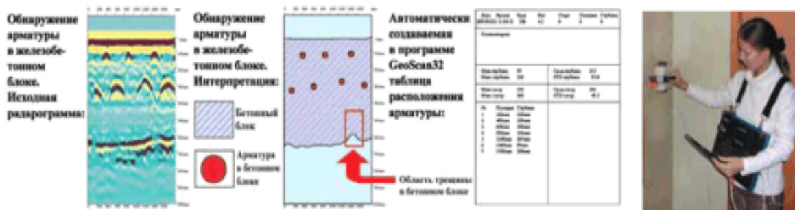
Рис. 37. Обследование строительных конструкций
