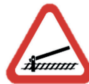
Рисунок 10 – Знак с символом шлагбаума, применяемый в Чили, адаптированный под систему дорожных знаков, соответствующих Конвенции
