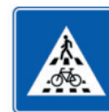
Рисунок 7 – Знак «Пешеходный переход и велосипедный переход, расположенные в непосредственной близости друг от друга»
