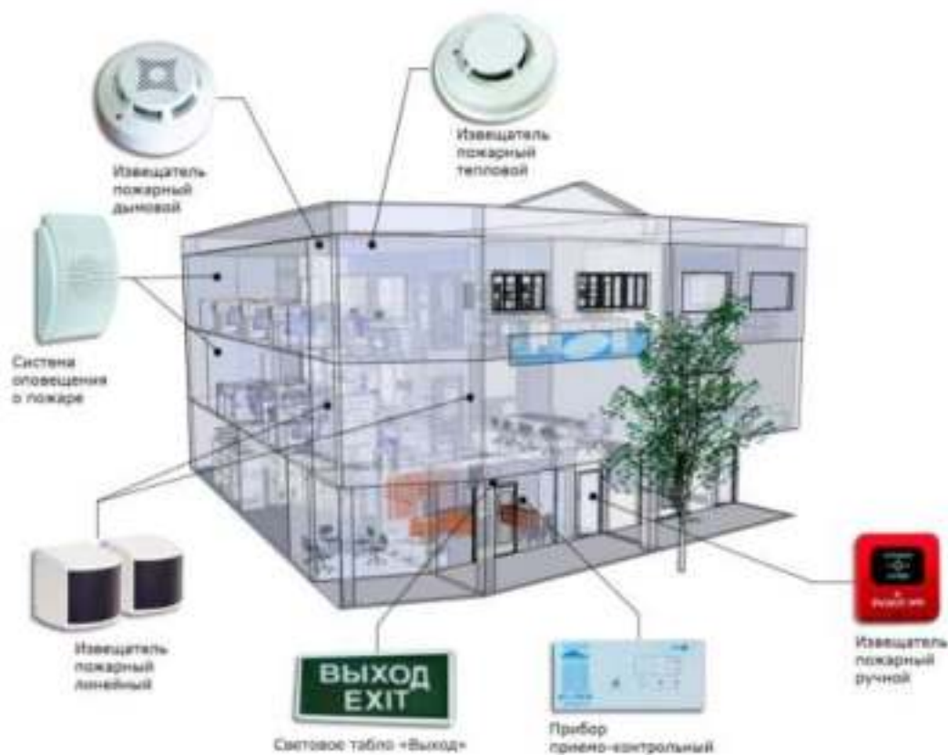
Рис. 2.13. Элементы пожарной сигнализации
