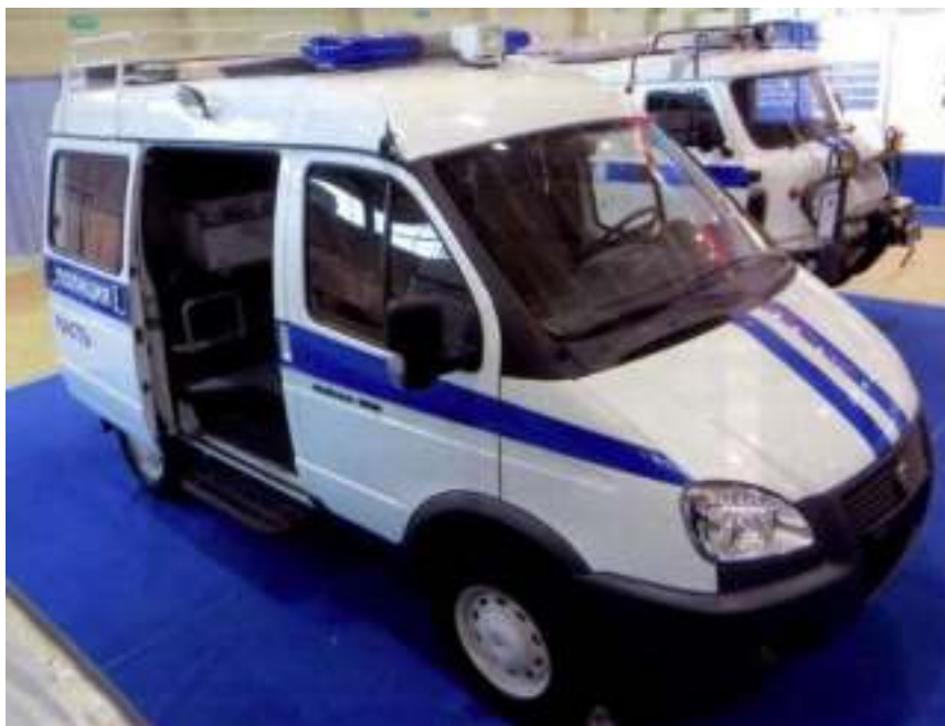
Рис. 4.70. Автомобиль дежурной части (АДЧ) ГАЗ 221757 на базе автомобиля «Соболь» 4х4
