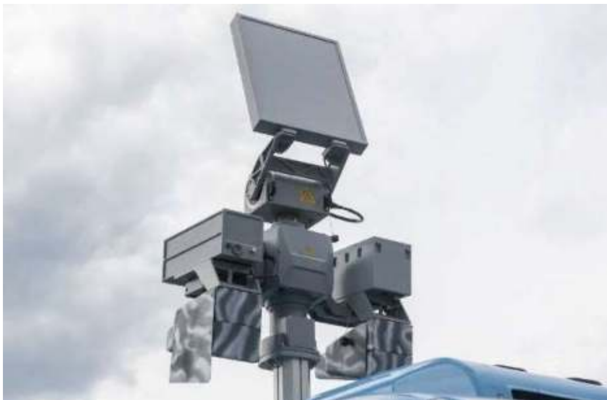
Рис. 3.60. Мультисистемный многофункциональный модуль комплекса «Сапсан-Бекас»
