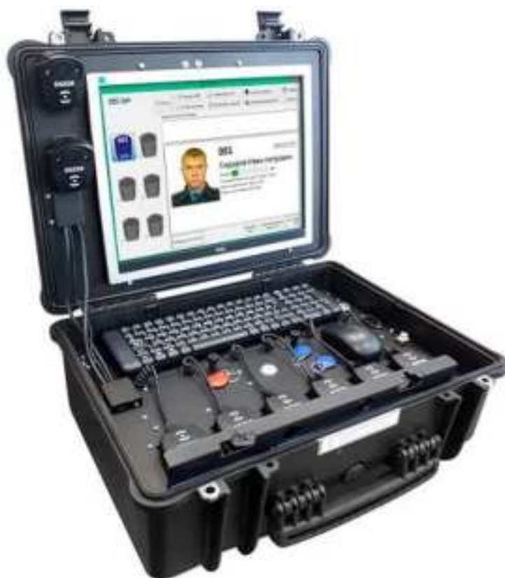
Рис. 4.28. Переносной терминал на 6 регистраторов с ПО «Дозор-Про»
