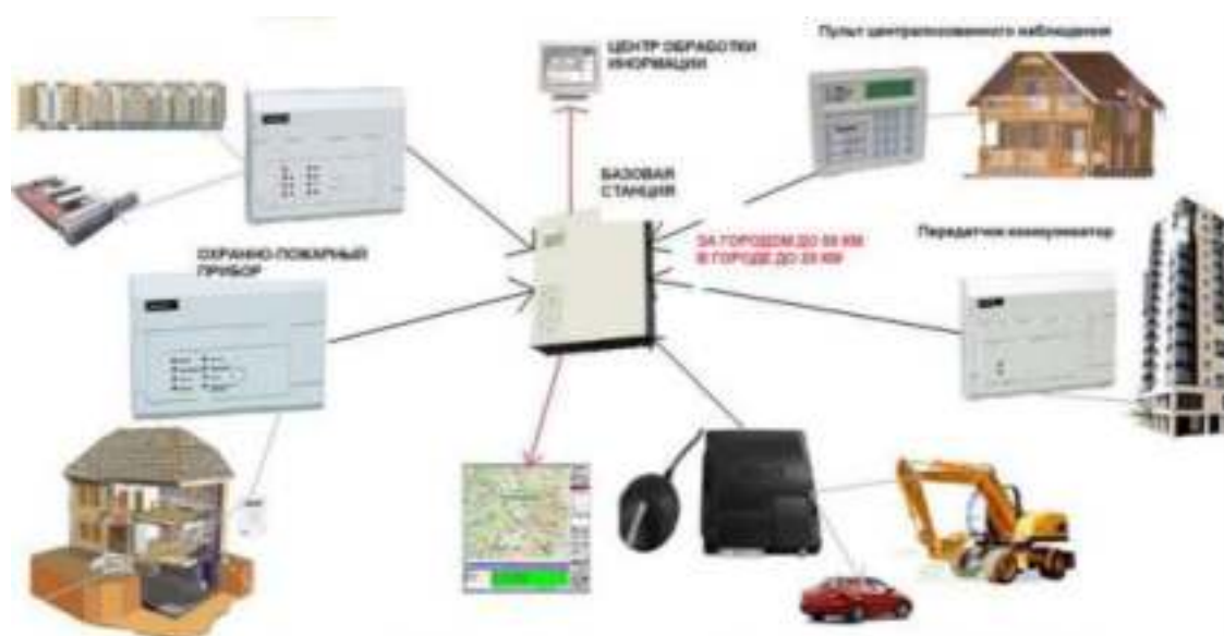
Рис. 2.10. Типовая централизованная система охраны объекта
