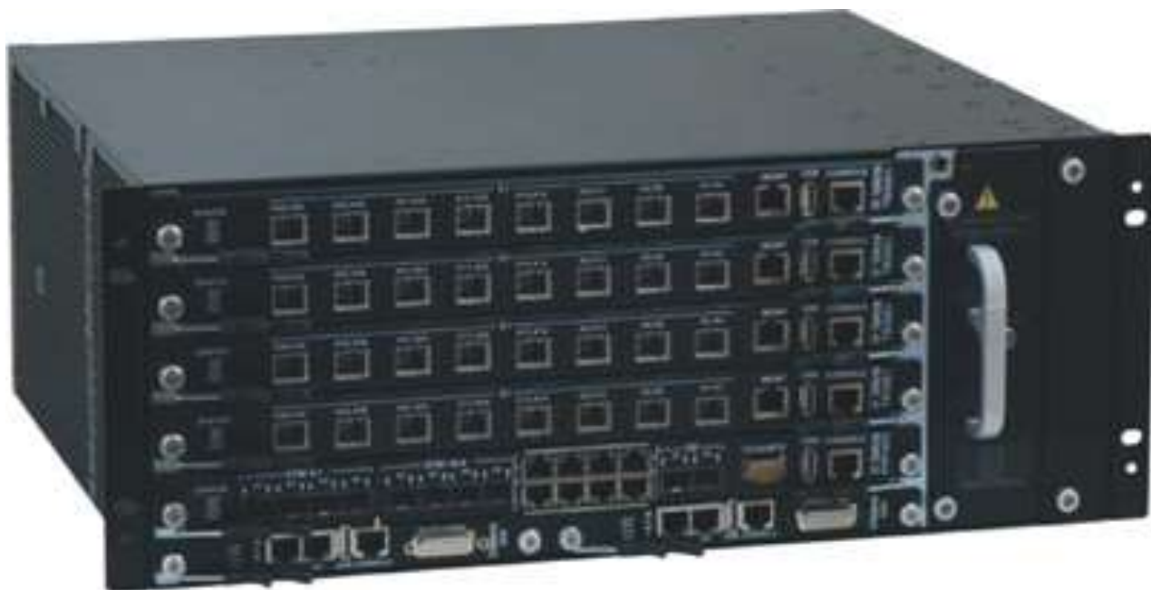
Рис. 1.6. Мультиплексор STM16 Alcatel-Lucent WaveStar ADM 16/1
