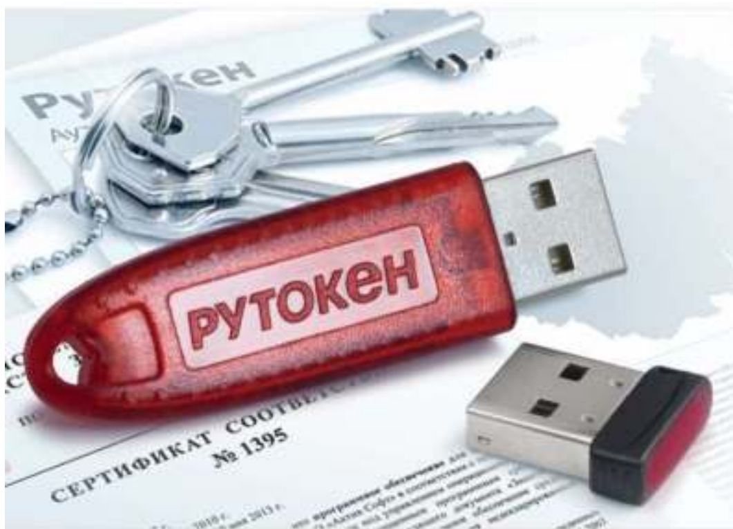
Рис. 1.35. Электронный идентификатор (токен) Рутокен S
