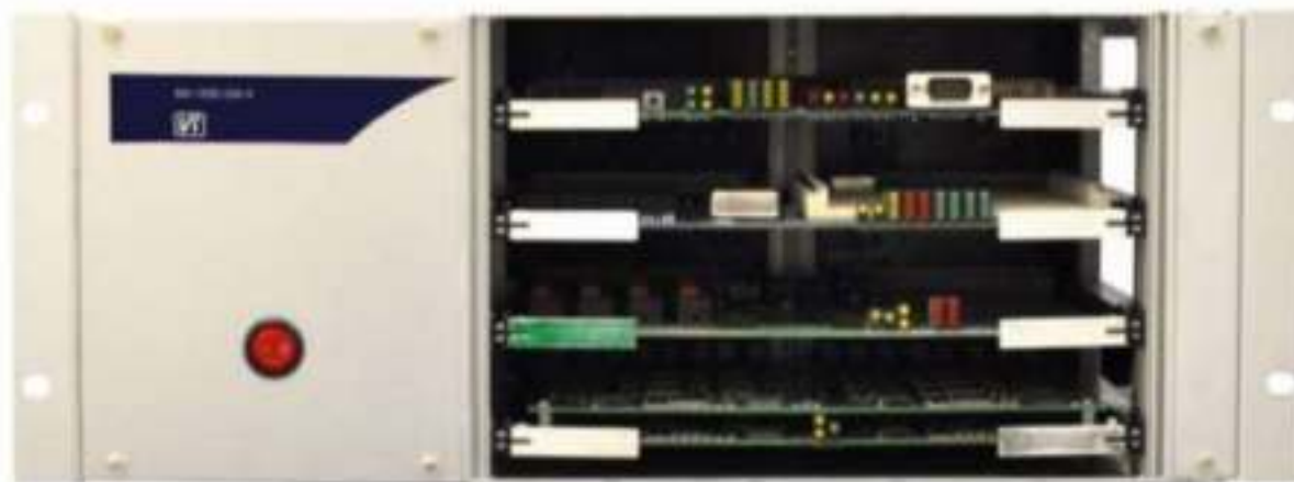
Рис. 1.22. Шлюз абонентских и соединительных линий МХ-1 000-GW
