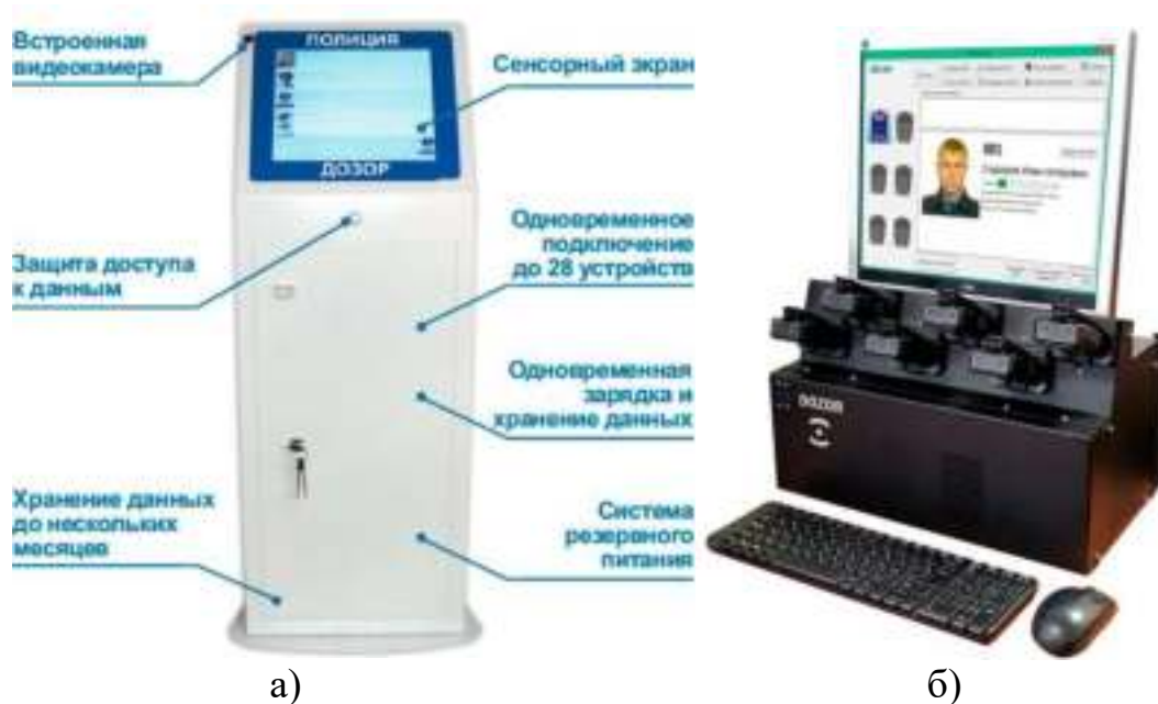
Рис. 4.30. Стационарные терминалы на 28 видеорегистраторов (рис. 4.30 а)) и на 6 видеорегистраторов (рис. 4.30 б))
