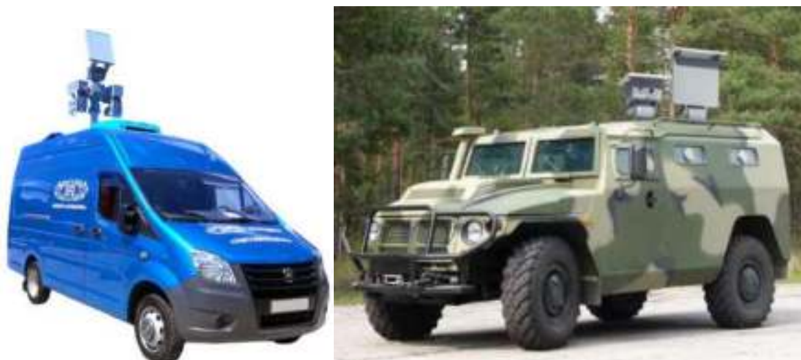
Рис. 3.59. Многофункциональный мобильный комплекс противодействия беспилотным летательным комплексам «Сапсан-Бекас»
