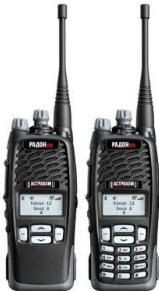
Рис. 1.47. Носимая радиостанция УКВ-диапазона «Радон-353/354»
