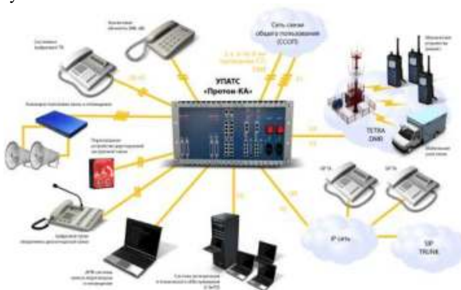
Рис. 1.19. Схема организации связи с использованием УПАТС «Протон-КА»
