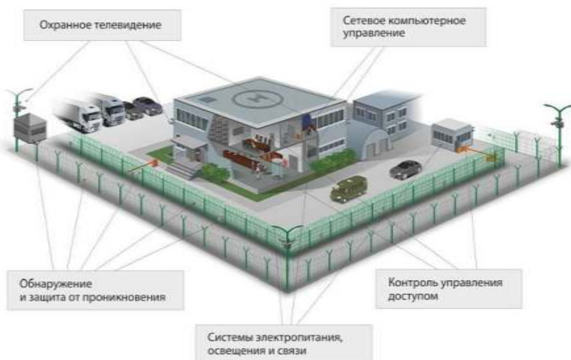
Рис. 2.5. Вариант выполнения требований по инженерно-технической укрепленности объекта
