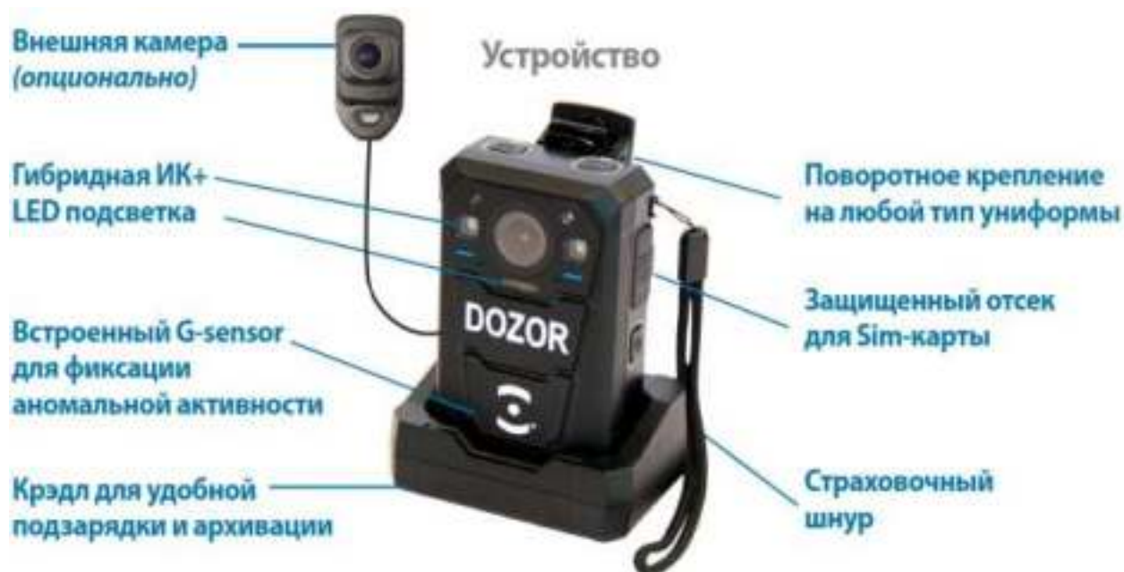
Рис. 4.27. Конструкция персонального носимого устройства регистрации информации «Дозор-78»
