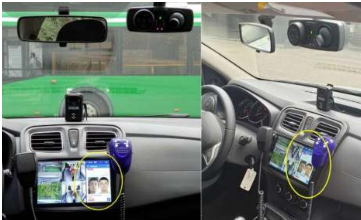
Рис. 4.37. Интеграция видеорегистратора «Дозор-78» с аппаратно-программным комплексом «Патруль»
