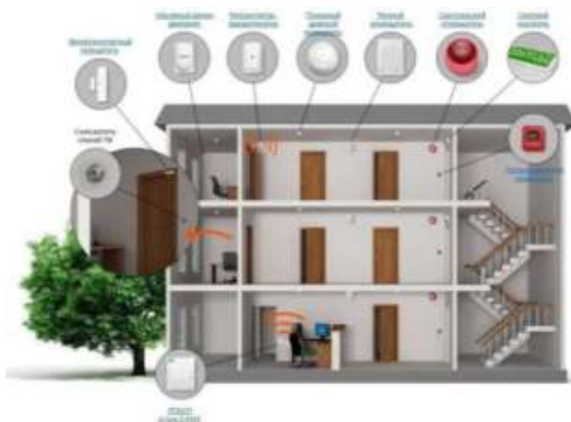
Рис. 2.57. Схема комплекса беспроводной сигнализации «Астра-Зитадель»
