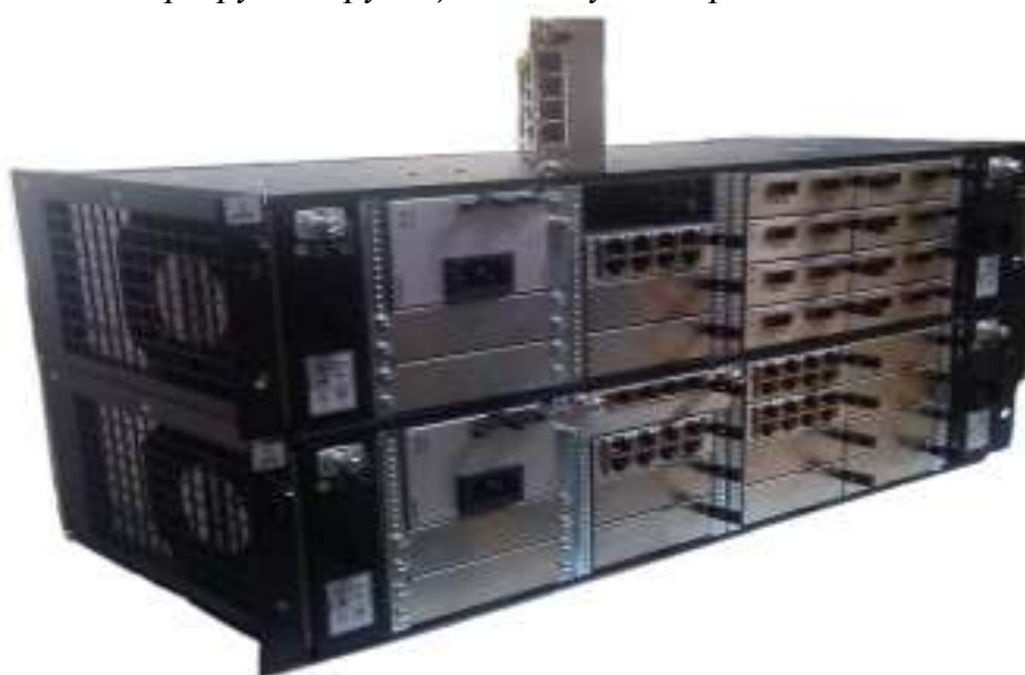
Рис. 1.16. Маршрутизирующий коммутатор «Поток-КМ-2420»
