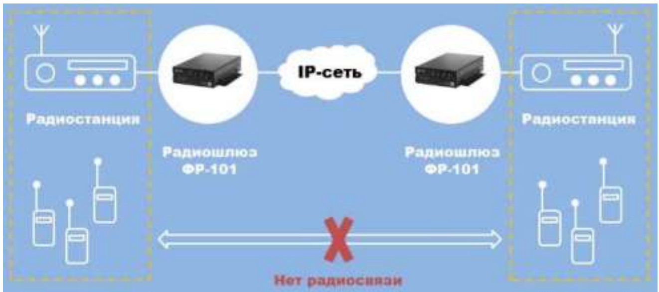
Рис. 1.80. Объединение двух зон радиосвязи через IP-сеть
