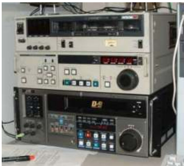
Рис. 2.77. Специализированные видеоманитофоны с тревожными входами
