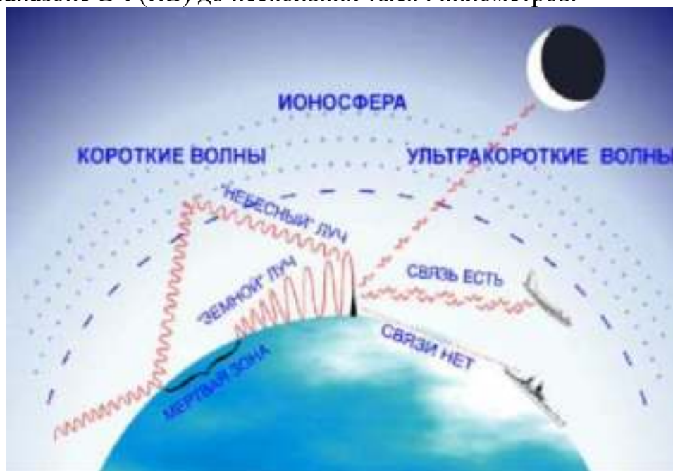
Рис. 1.36. Распространение поверхностных и пространственных волн ВЧ-диапазона 1
