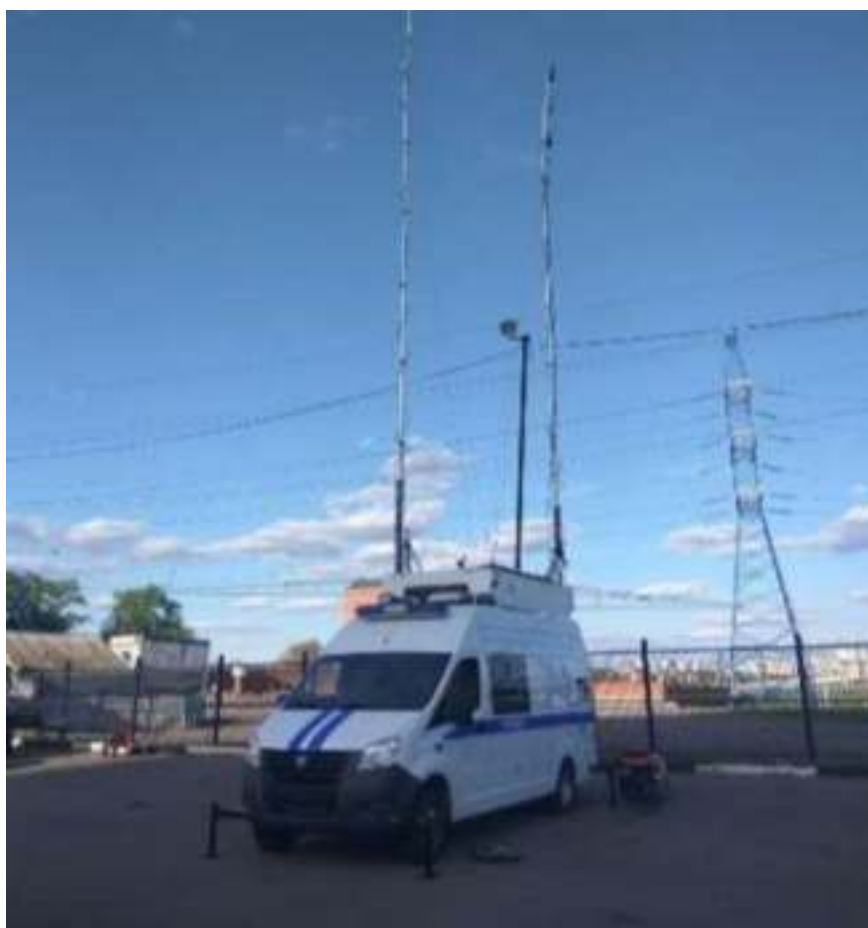
Рис. 1.66. Подвижный узел связи (ПУС) модели 5027G
