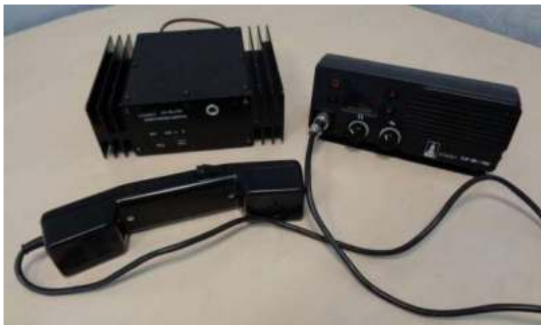
Рис. 1.42. Блок приемовозбудителей, пульт управления и микрофонная трубка стационарной цифровой КВ/УКВ-радиостанции «Стилет 1,5-30,0/160»
