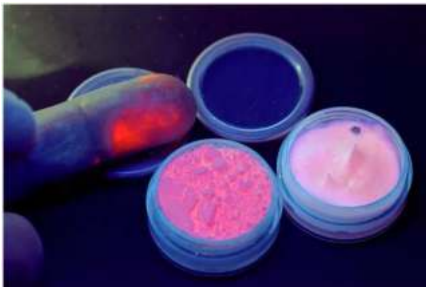
Рис. 3.31. Порошок и мазь «Орлюм» повышенной адгезии, с различной областью свечения 365 / 254 / 980 нм
