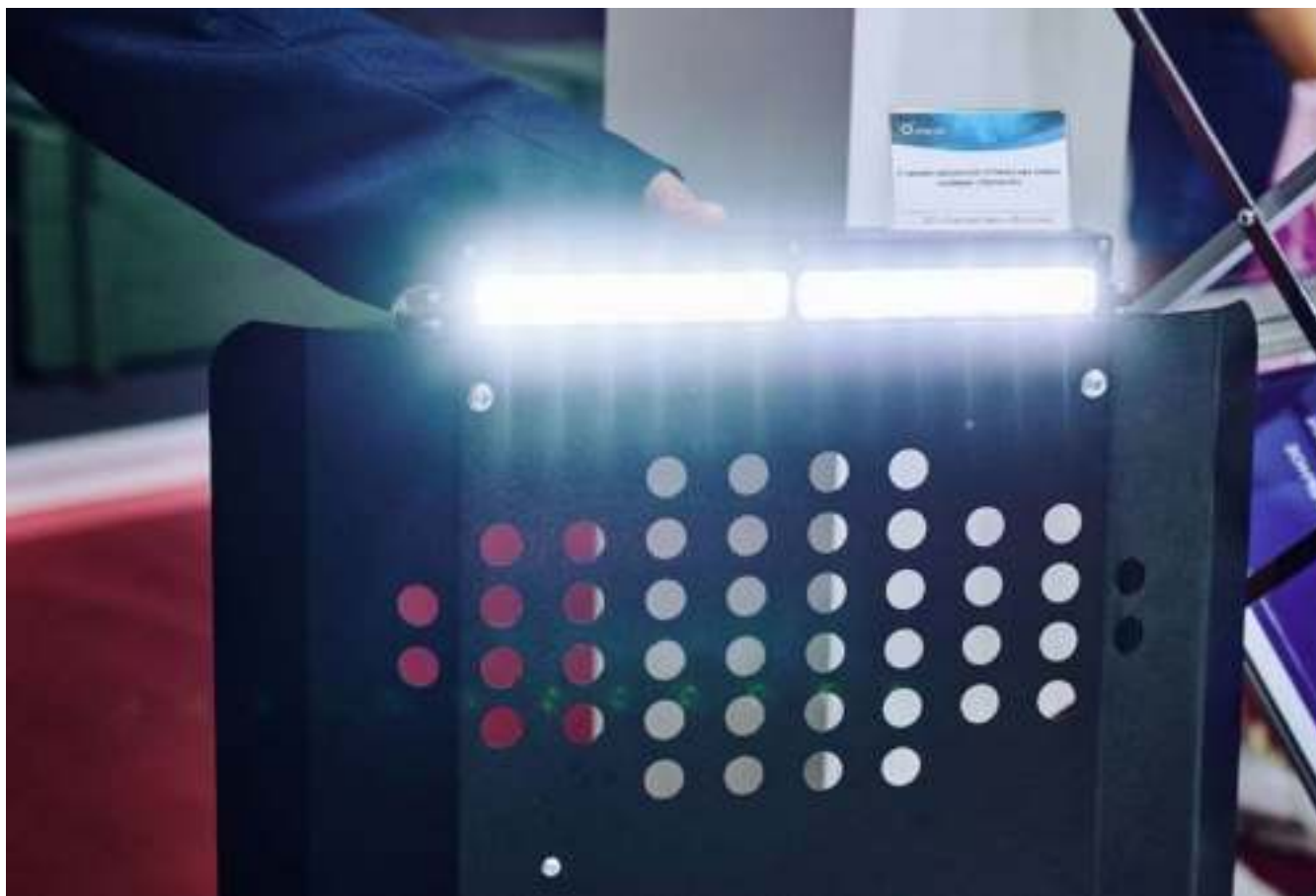
Рис. 3.29. Станция визуально-оптических помех «Лютик-Н», смонтированная на противоударный щит
