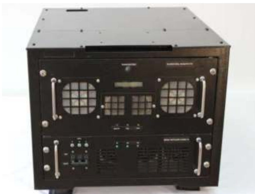
Рис. 1.43. Стойка с усилителем мощности 1000 Вт и блоком питания стационарной цифровой КВ/УКВ-радиостанции «Стилет 1,5-30,0/160»
