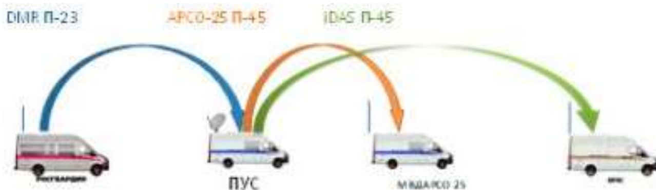
Рис. 1.56. Схема организации межведомственной радиосвязи при движении в колонне
