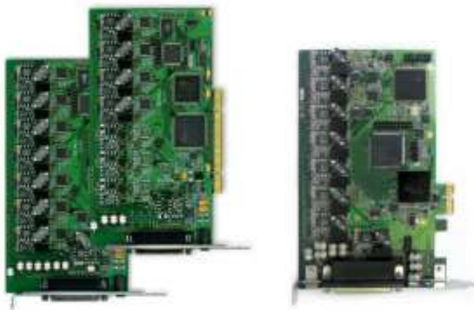
Рис. 4.5. Внешний вид интерфейсных плат многоканальной системы регистрации телефонных вызовов и речевых сообщений «Незабудка II»
