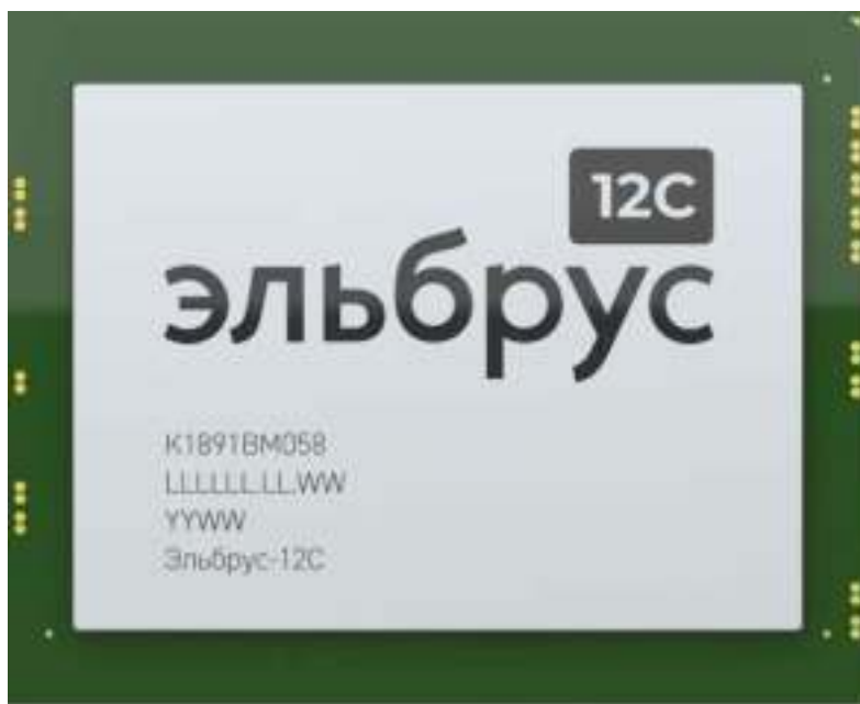
Рис. 1.29. Центральный процессор «Эльбрус-12С»
