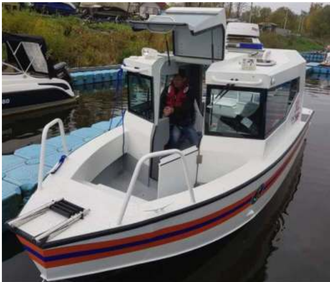
Рис. 4.98. Откидная носовая дверь на газовых амортизаторах и распашная калитка рубки
