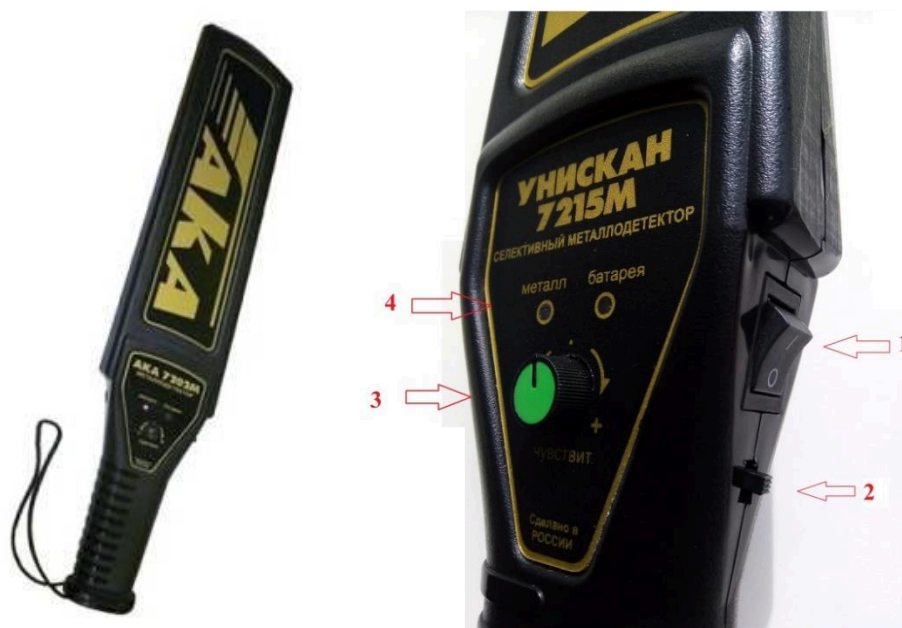
Рис. 6. Ручной селективный металлодетектор АКА «Унискан 7215М» 1 – клавиша включения металлоискателя; 2 – переключатель режима обнаружения всех металлов либо только черных металлов; 3 – ролик настройки чувствительности; 4 – световой индикатор обнаружения металла
