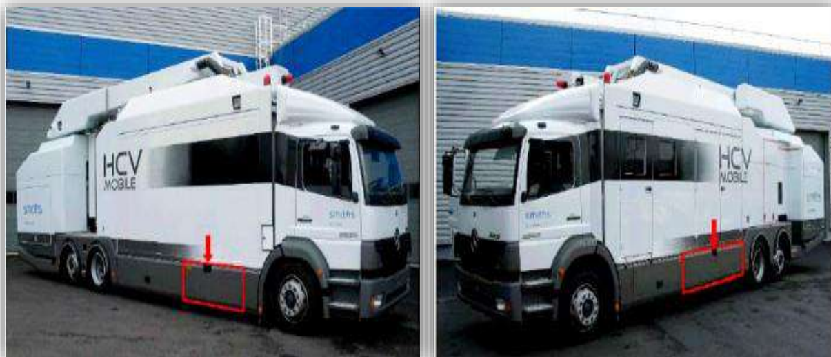
Рис. 52. Расположение баков с дизельным топливом для двигателя тягача (слева) и электрогенератора (справа)
