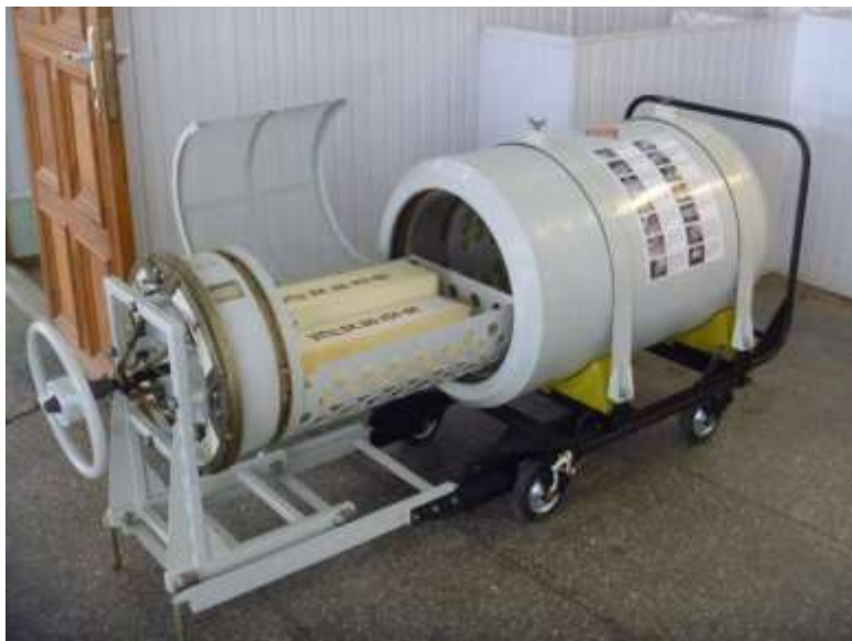
Фото 14. Взрывозащитный контейнер ЭТЦ-3
