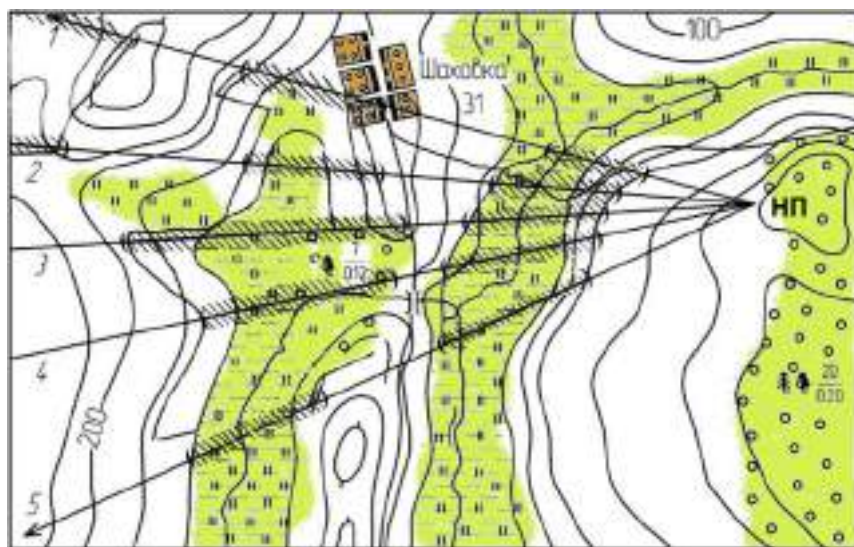
Рис. 1.61. Обозначение невидимых участков скобками на профильных линиях
