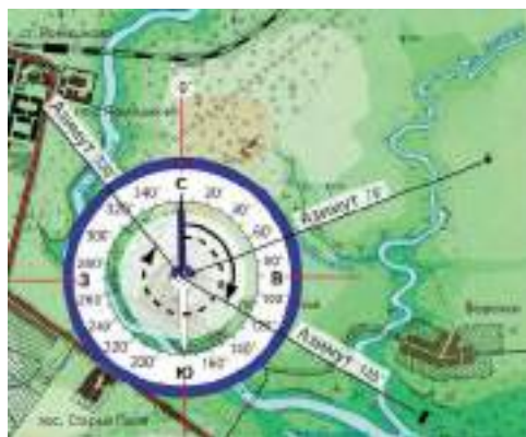
Рис. 1.80. Определение азимута на карте по компасу
