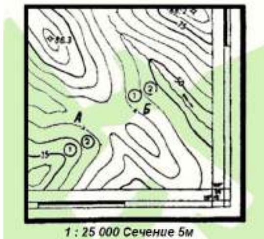
Рис. 1.40. Определение на карте господствующих точек по отметкам горизонталей у рамки карты
