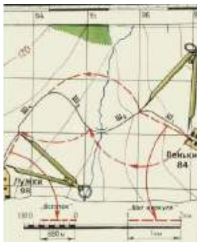
Рис. 1.5. Схема измерения извилистой линии циркулем-измерителем
