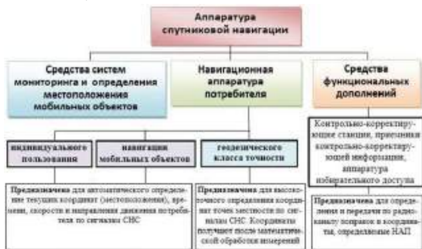
Рис. 2.19. Классификация навигационной аппаратуры потребителей спутниковой навигации
