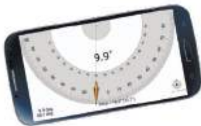
Рис. 1.45. Угол отклонения равен крутизне ската
