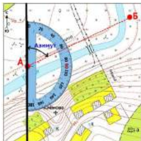
Рис. 1.81. Определение азимута на карте по транспортиру
