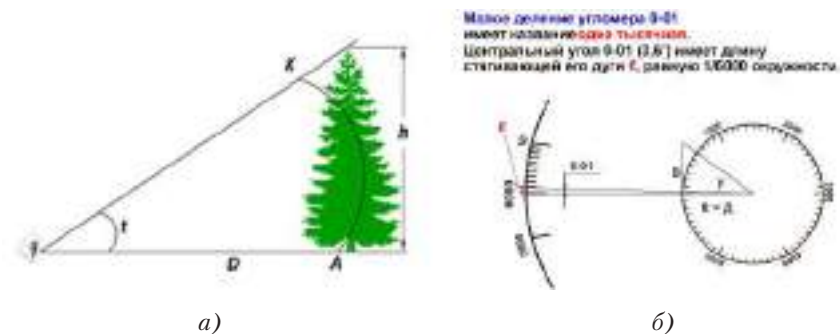
Рис. 1.9. Определение расстояния по измеренным угловым размерам и известной высоте предмета
