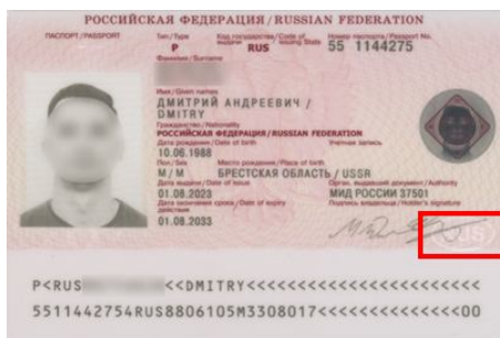
Рис. 14. Страница данных паспорта Российской Федерации (рамкой красного цвета обозначено место расположения скрытого лазерного изображения в виде символов «РФ RUS»)
