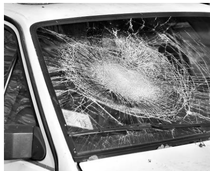
Рис. 5б. Картина разрушения ветрового стекла при ударе большим камнем
