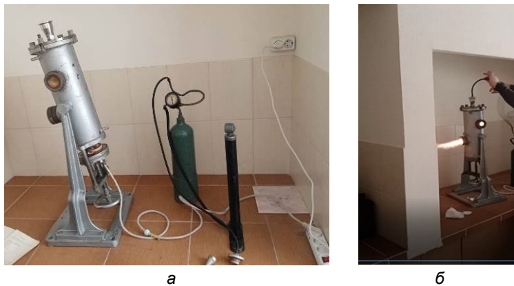
Рис. 6. Взрывной цилиндр: а – до проведения эксперимента; б – результат проведения эксперимента
