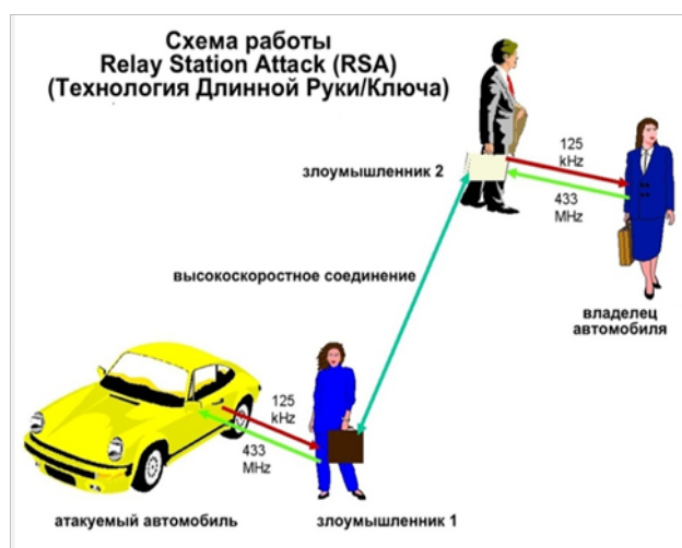
Рис. 2. Принцип работы ретранслятора (повторителя) сигнала
