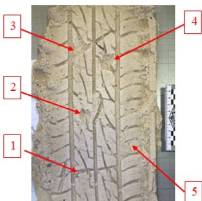
Рис. 12. Гипсовый слепок, изготовленный со следа отображения исследуемой шины
