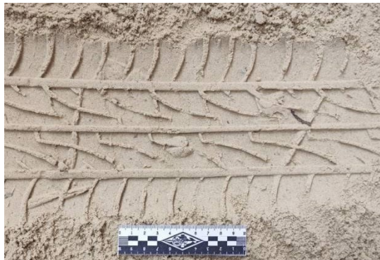
Рис. 4. Объемный след протектора шины, образованный на влажном грунте фрагментом беговой дорожки исследуемой шины
