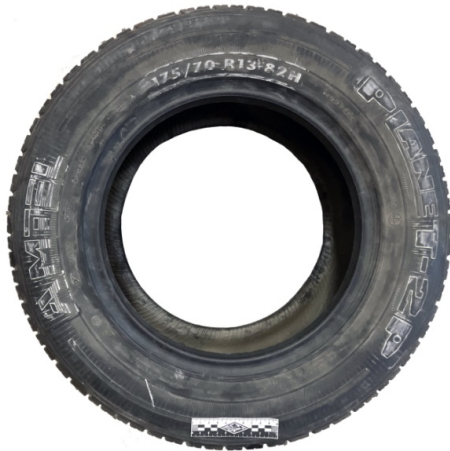
Рис. 2. Исследуемая шина марки AMTEL PLANET-2P 175/70 R13 – 82H
