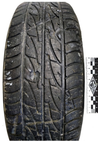
Рис. 3. Выбранный фрагмент беговой дорожки исследуемой шины
