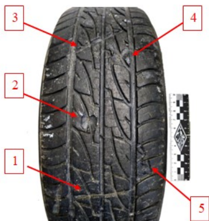
Рис. 10. След беговой дорожки фрагмента исследуемой шины
