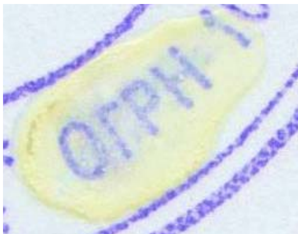
Рис. 36. Текст документа, проявившийся в процессе высыхания корректирующего вещества
