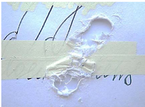
Рис. 44. Удаленные слой ленты-корректора и штрихи материала письма, находящиеся под корректирующим веществом, из-за разволокнения бумаги после воздействия на данный участок водой
