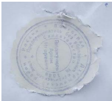
Рис. 31. Разволокнение бумаги по контуру слоя корректирующего вещества на водной основе при попытке смыть его водой
