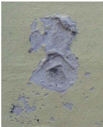
Рис. 40. Удаленный вместе с бумагой слой корректирующего средства на спиртовой основе
