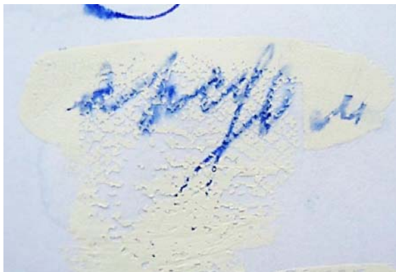
Рис. 37. Отслоение части корректирующего средства при использовании органического растворителя (диметилформаида)
