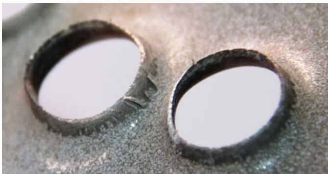
Рис. 16. Форма краев металла у выходного отверстия при попадании пули калибра 9 мм ПМ, имеющей полусферическую форму головной части
