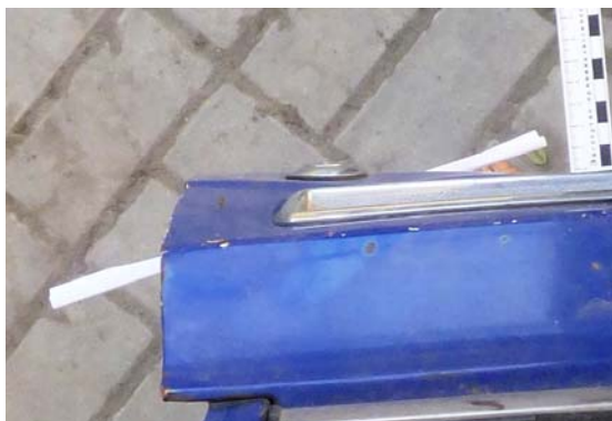
Рис. 53. Определение вертикального угла встречи снаряда с преградой
