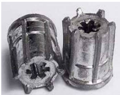
Рис. 7. Пуля турбинная Майера, имеющая шесть выступающих граней
