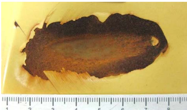
Рис. 3. Касательное огнестрельное повреждение на металлической преграде
