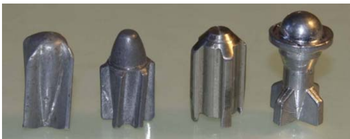
Рис. 9. Стрелочные пули, имеющие различную форму и количество выступающих граней
