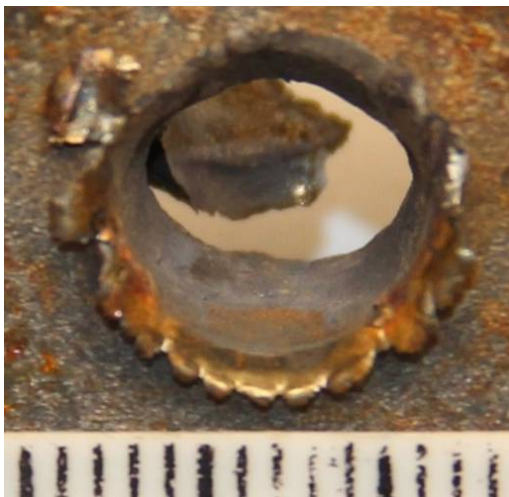
Рис. 1. Сквозное огнестрельное повреждение на металлической преграде
