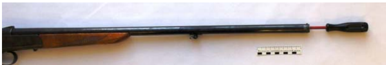
Рис. 60. Измерение глубины погружения оружейного шомпола в ствол оружия
