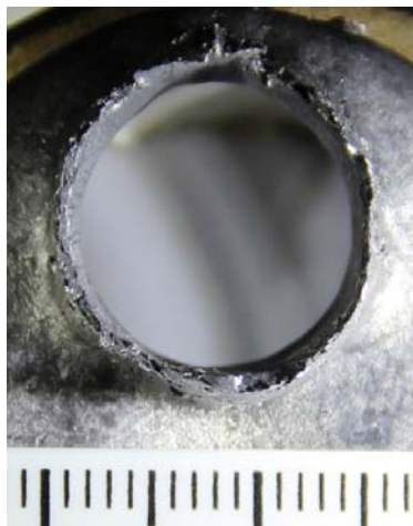
Рис. 19. Входное отверстие повреждения, образованного в результате выстрела из пистолета Макарова калибра 9 мм по свинцовой пластине
