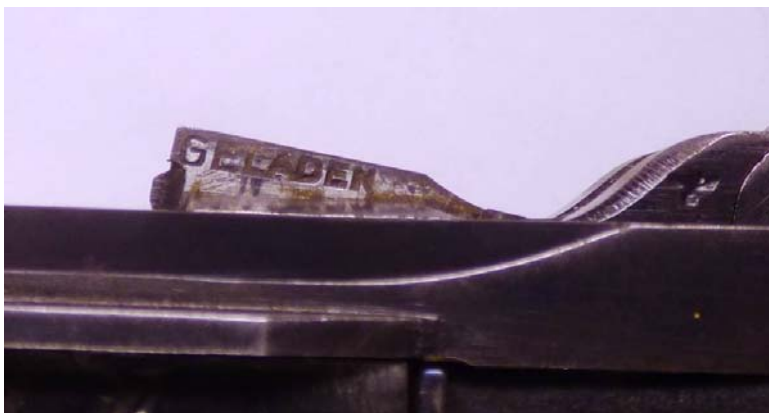
Рис. 54. Надпись «KNAL» или «GELADEN» на выступающей части выбрасывателя, сигнализирующая о наличии патрона в патроннике
