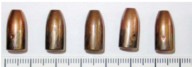
Рис. 14. Плоская форма головной части пули
