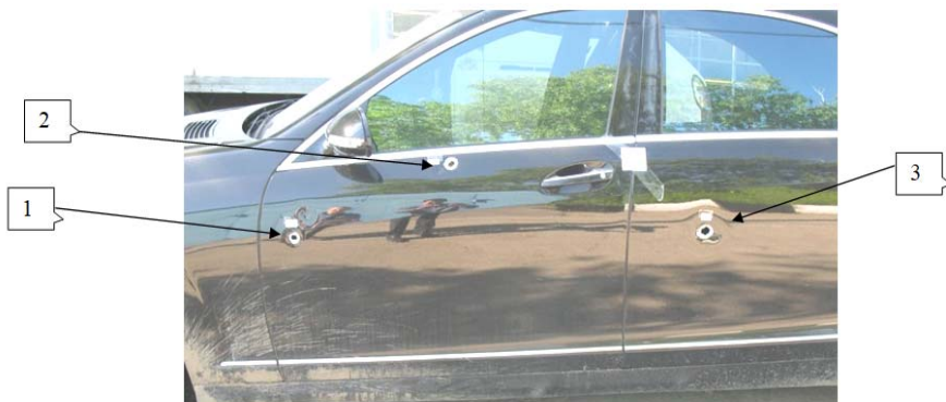
Иллюстрация 6. Повреждения № 1, № 2 и № 3 на левой передней и задней двери а/м «Мерседес-Бенц С 500» г/н ХХХ
