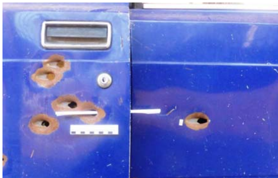
Рис. 52. Определение горизонтального угла встречи снаряда с преградой
