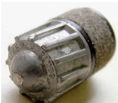
Рис. 8. Пуля стрелочная Бреннеке, имеющая двенадцать выступающих граней
