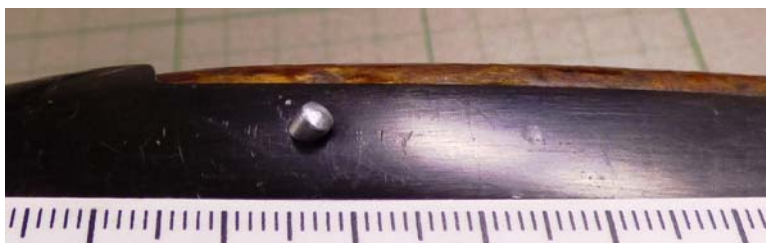
Рис. 55. Выступающая сигнальная спица ружья модели ИЖ-18, сигнализирующая о взведенном УСМ
