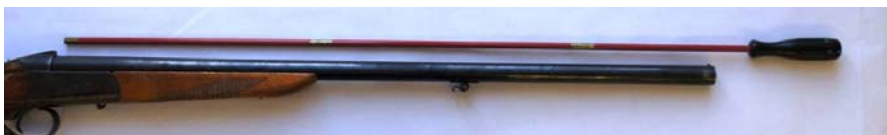
Рис. 59. Измерение длины ствола при помощи оружейного шомпола
