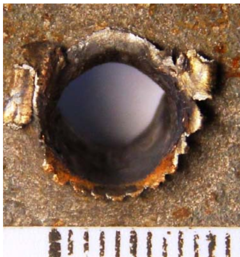
Рис. 23. Следы металлизации на пояске обтирания (оболочечная пуля)
