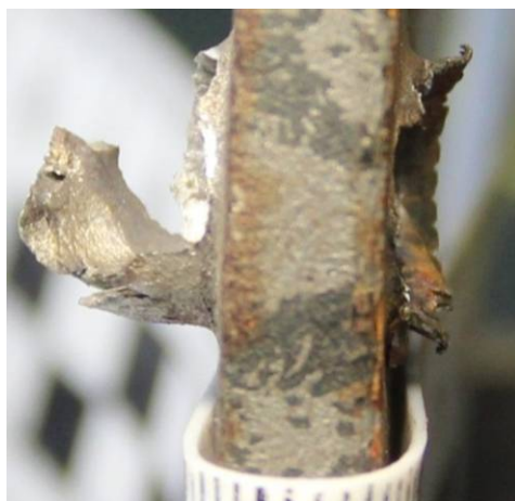
Рис. 5. Выплеск металла в сторону входного и выходного отверстия при образовании огнестрельного повреждения на металлической преграде
