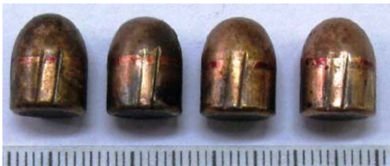
Рис. 13. Полусферическая форма головной части пули
