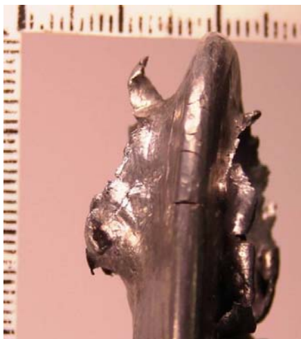
Рис. 18. Повреждение, образованное в результате выстрела из автомата модели АК-74 калибра 5,45 мм по свинцовой пластине
