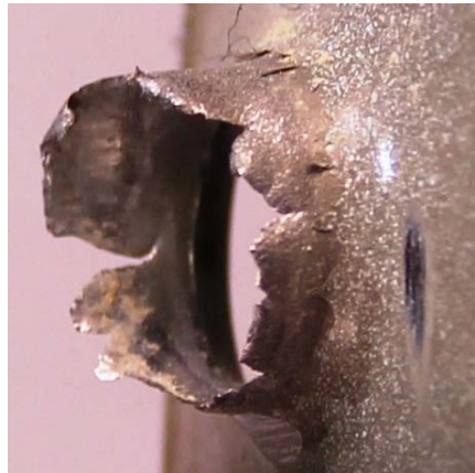
Рис. 15. Форма краев металла у выходного отверстия при попадании пули калибра 7,62 мм, имеющей остроконечную форму головной части
