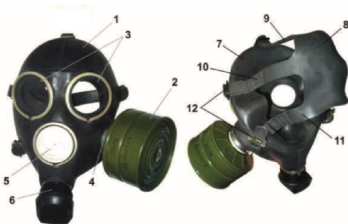
1 – лицевая часть; 2 – фильтрующе-поглощающая коробка; 3 – очковый узел с не запотевающими пленками; 4 – узел клапана входа; 5 – переговорное устройство (мембрана); 6 – узел клапана выдоха; 7 – обтюратор; 8 – наголовник (затылочная пластина); 9 – лобная лямка; 10 – височная лямка; 11 – щечная лямка; 12 – пряжки
