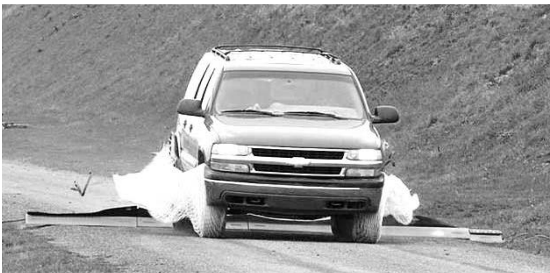
Устройство для принудительной остановки автотранспорта «Pit-BUL».
