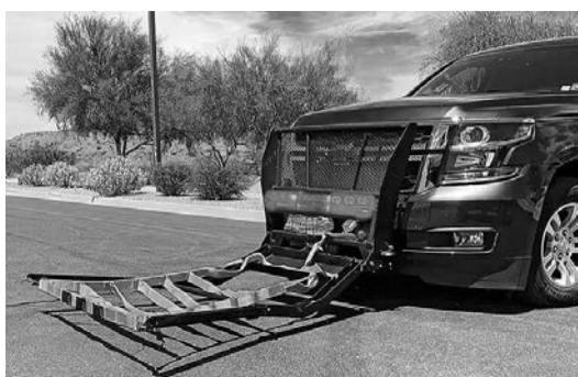
Устройство для принудительной остановки автотранспорта (грэпpler).
