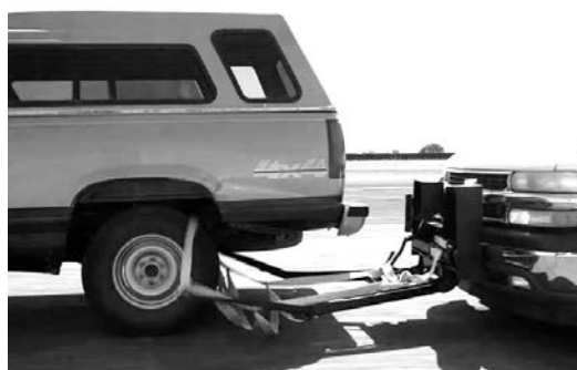
Устройство для принудительной остановки автотранспорта (грэпpler).
