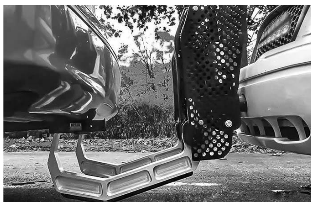
Устройство для принудительной остановки автотранспорта «Crukhook».
