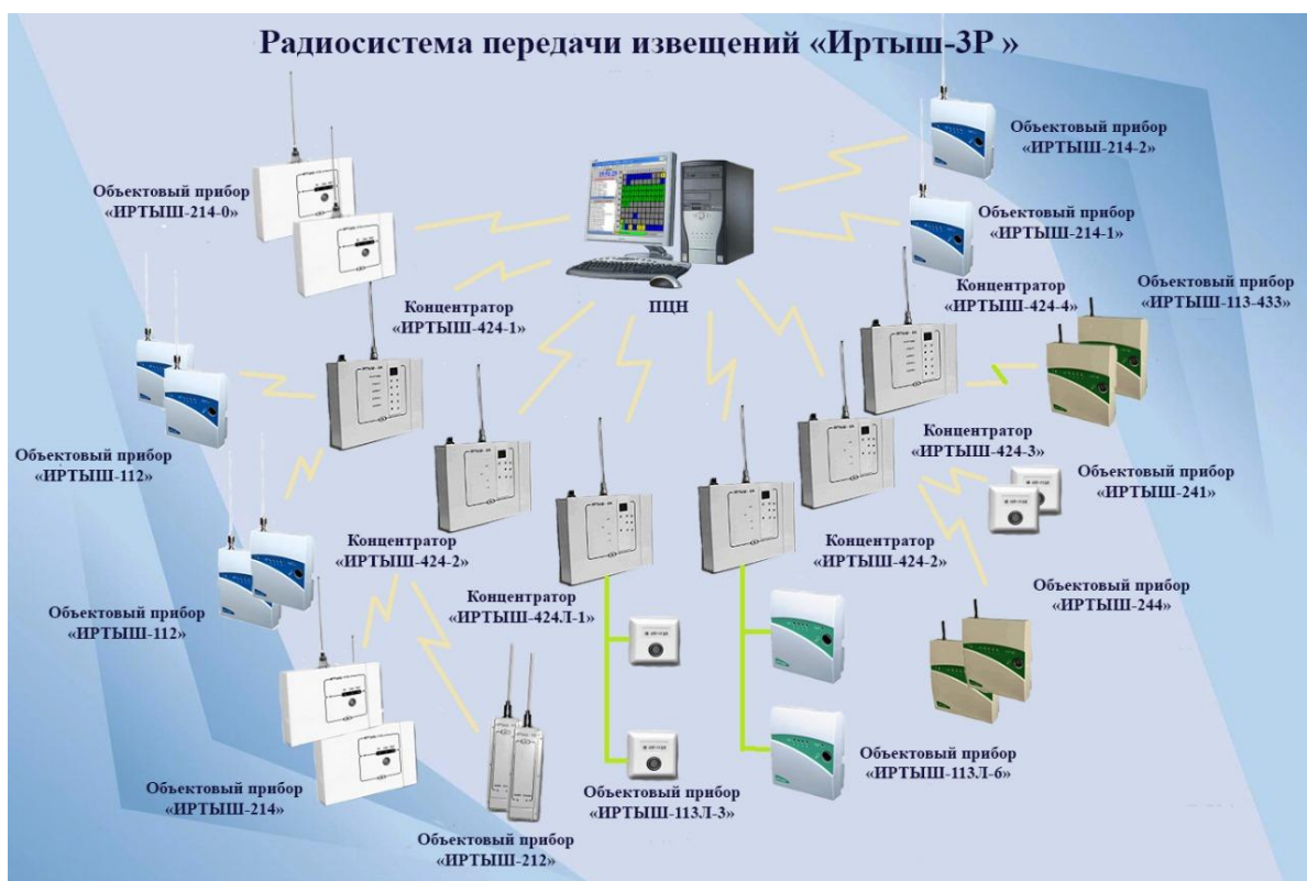
Рис. 5. Структурная схема работы РСПИ Иртыш-ЗР:
