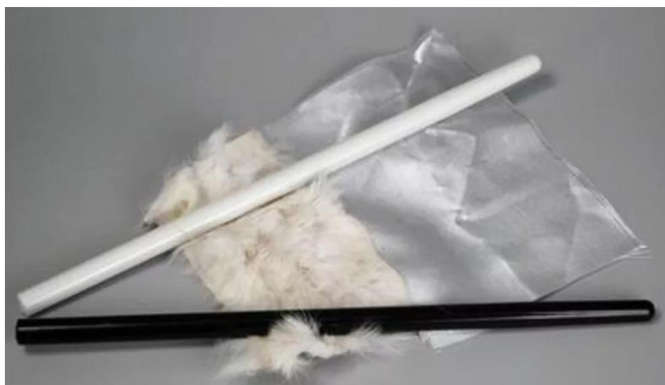
Рис. 2. Электростатические палочки для изъятия микрообъектов
