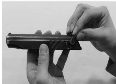
Рис. 2.25. Отделение предохранителя от затвора
