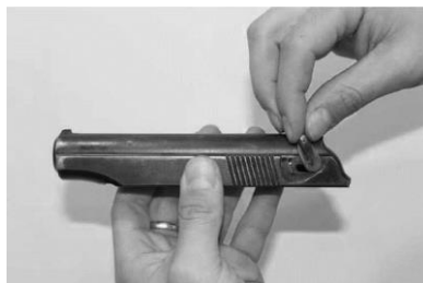
Рис. 2.30. Присоединение предохранителя к затвору
