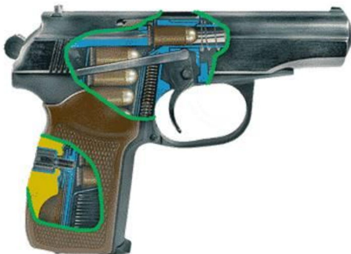
Рис. 2.13. Положение частей и механизмов пистолета перед выстрелом в момент спуска курка с боевого взвода [5, с. 103]
