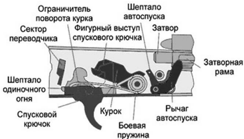
Рис. 1.67. Работа частей и механизмов при стрельбе одиночными выстрелами
