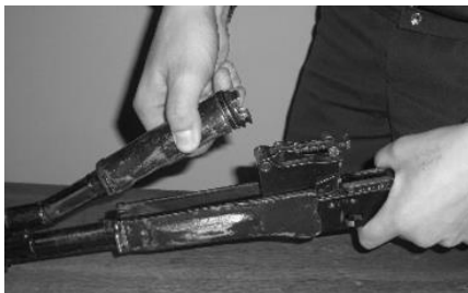
Рис. 1.45. Отделение газовой трубки со ствольной накладкой
