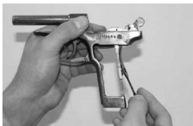
Рис. 2.32. Присоединение боевой пружины к рамке
