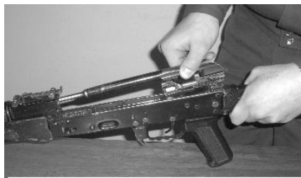
Рис. 1.43. Отделение затворной рамы с затвором
