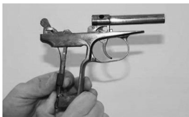
Рис. 2.33. Закрепление боевой пружины задвижкой
