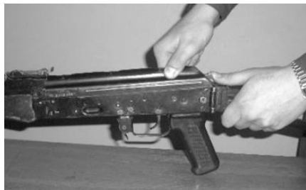
Рис. 1.41. Отделение крышки ствольной коробки
