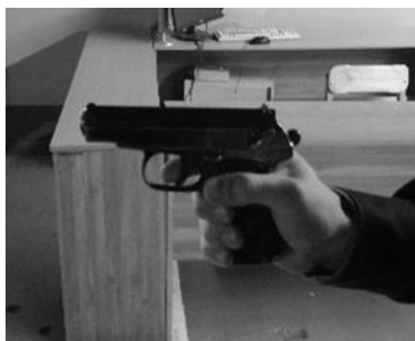
Рис. 2.73а. «Свободный» ход спускового крючка
