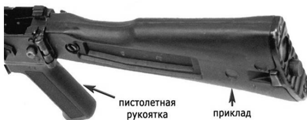
Рис. 1.56. Приклад и пистолетная рукоятка
