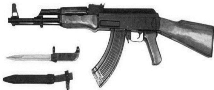
Рис. 1.11. 7,62 мм автомат Калашникова образца 1947 года [5, с. 119]
