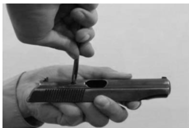
Рис. 2.29. Присоединение выбрасывателя к затвору
