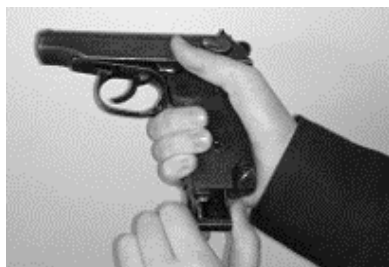
Рис. 2.14а. Извлечение магазина из основания рукоятки
