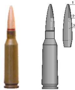
Рис. 1.70. 5,45 мм патрон ПС с обыкновенной пулей (индекс 7Н6): 1 — оболочка; 2 — рубашка; 3 — сердечник
