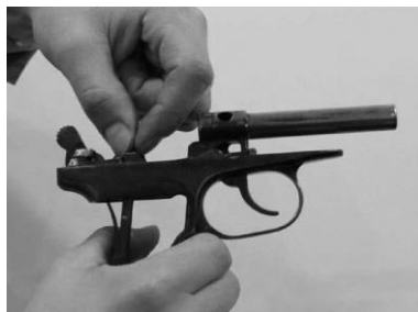
Рис. 2.34. Присоединение затворной задержки и шептала к рамке
