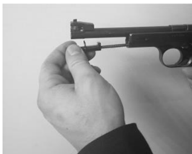
Рис. 2.53. Отделить возвратный механизм
