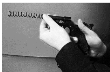
Рис. 2.16. Снятие возвратной пружины
