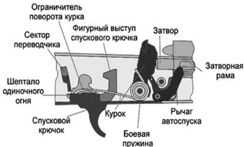
Рис. 1.65. Положение частей и механизмов до заряжания
