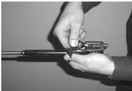
Рис. 1.44. Отделение затвора от затворной рамы
