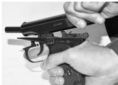
Рис. 2.15. Снятие затвора [6, с. 158]
