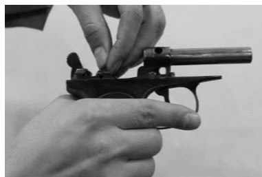
Рис. 2.20. Отделение шептала и затворной задержки от рамки
