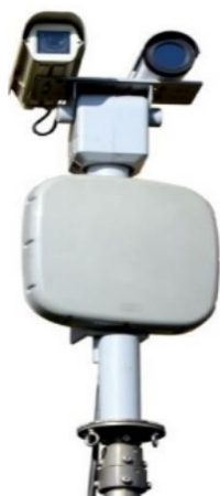
Рис. 3.13. Внешний вид РЛС «Радескан» в комплексе с тепловизором
