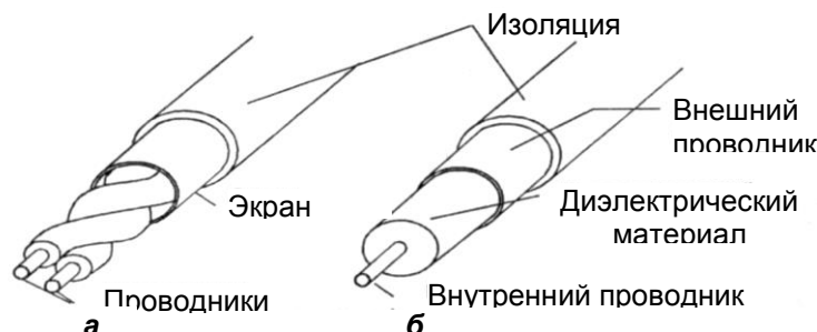
Рис. 1.7. Типичный вид симметричного провода (а) и коаксиального провода (б)
