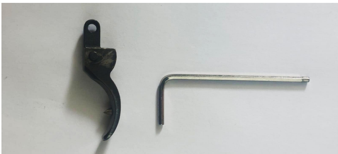
Рис. 33. Резьбовой «гужон» должен быть с внутренним шестигранником
