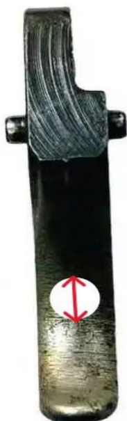
Рис. 29. Отверстие в центре спускового крючка на вышеуказанной высоте
