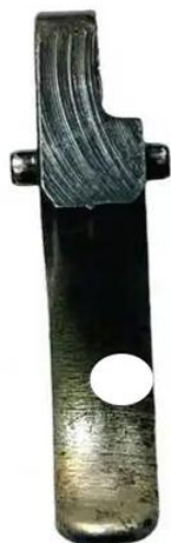
Рис. 30. Неудачно просверленное отверстие
