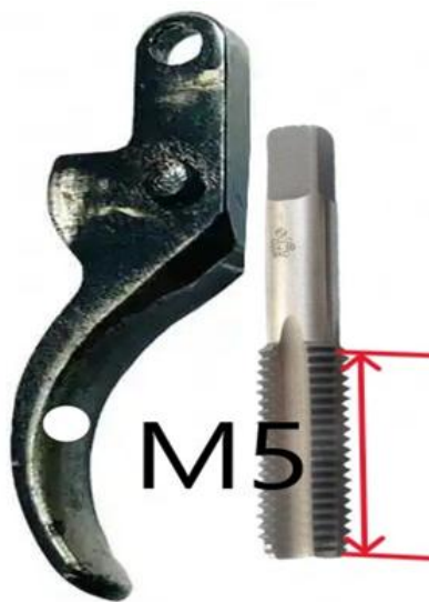
Рис. 31. Метчик, правильный «шаг» внутренней резьбы – размер M5
