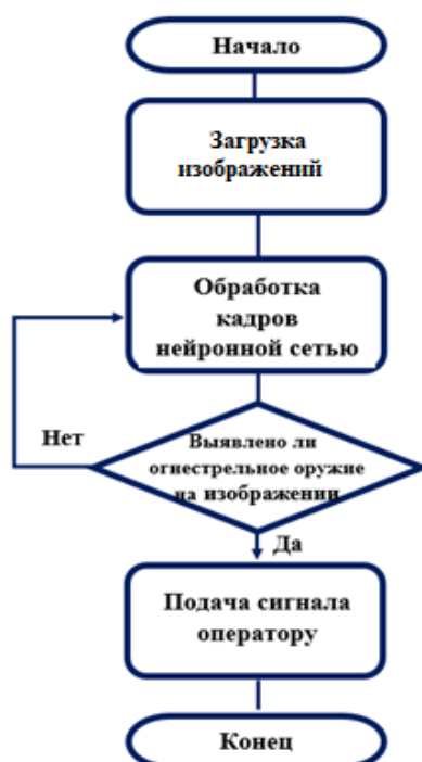
Рис. 2. Блок-схема алгоритма системы детектирования и классификации огнестрельного оружия
