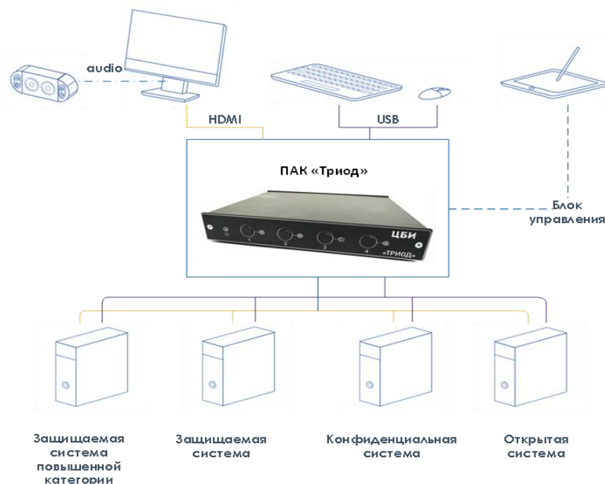
Рис. 2. Схема подключения ПАК «Триод»
