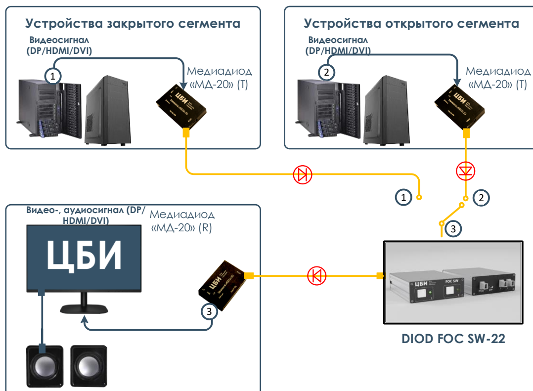
Рис. 4. Схема подключения изделия «ОП-22» (DIOD FOC SW-22)
