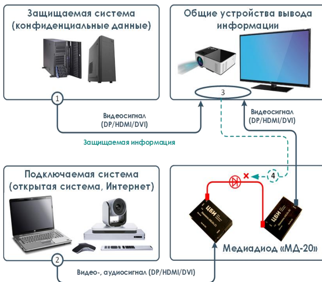
Рис. 3. Схема подключения изделия «Медиадиод МД-20»
