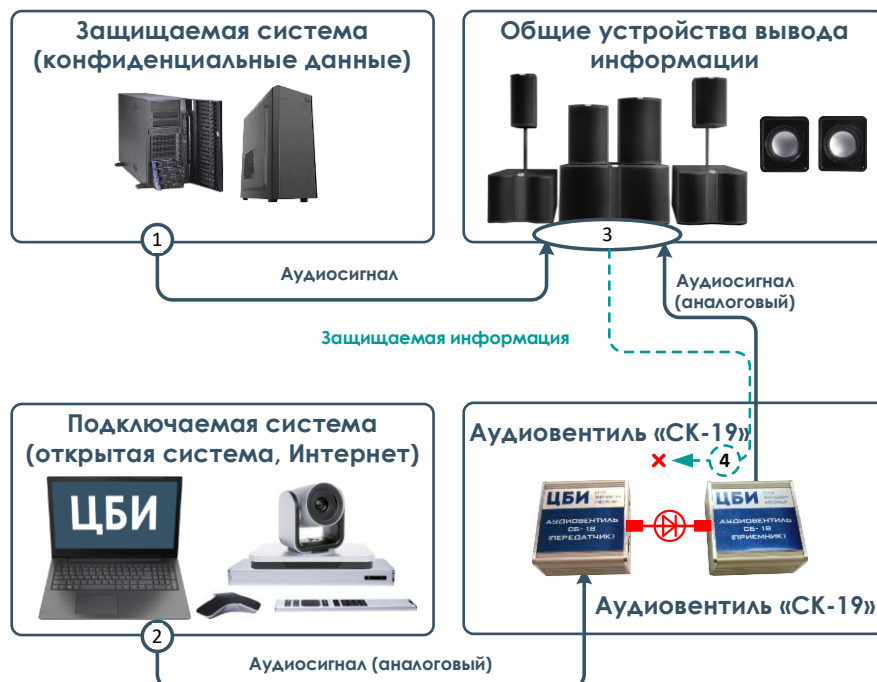
Рис. 6. Схема подключения изделия «Аудиовентиль СК-19»
