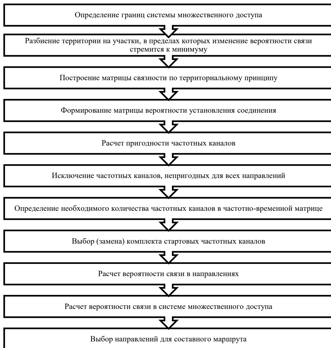
Рис. 4. Схема оптимизации параметров алгоритма множественного доступа пакетной радиосвязи
