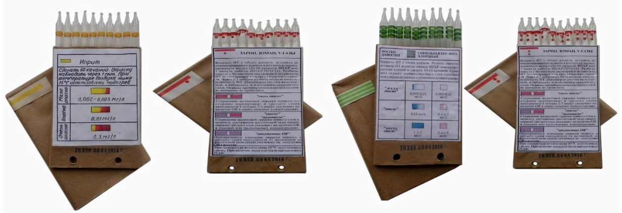
Рис. 18. Индикаторные трубки (а – ИТ-36, б – ИТ-44, в – ИТ-45, г – ИТ-51)
