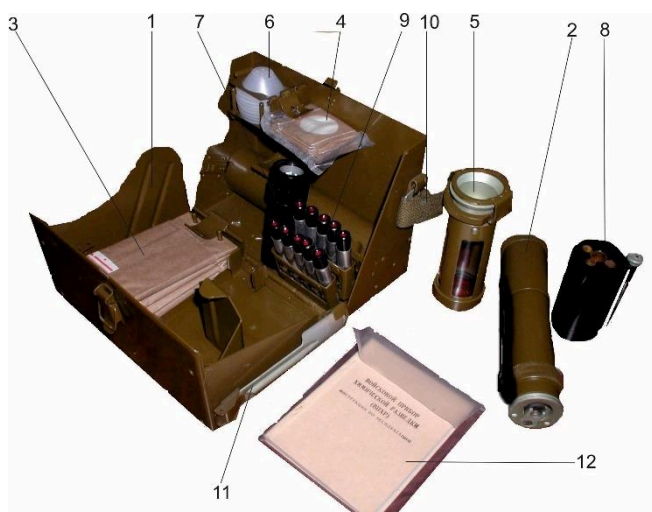
Рис. 16. Войсковой прибор химической разведки: 1 – корпус прибора; 2 – насос; 3 – бумажные кассеты с индикаторными трубками; 4 – противодымные фильтры; 5 – насадка к насосу; 6 – колпачки для насадки; 7 – электрофонарь; 8 – грелка со штырем; 9 – патроны для грелки; 10 – ремни; 11 – лопатка; 12 – документация.
