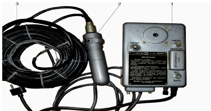
Рис. 10. Индикатор-сигнализатор ДП-64: 1 – пульт сигнализации; 2 – датчик; 3 – кабель.
