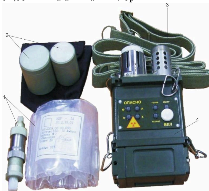
Рис. 17. Газосигнализатор войсковой автоматический ГСА-3: 1 - комплект ЗИП-О; 2 - колпаки; 3 - ремни; 4 - блок индикации.
