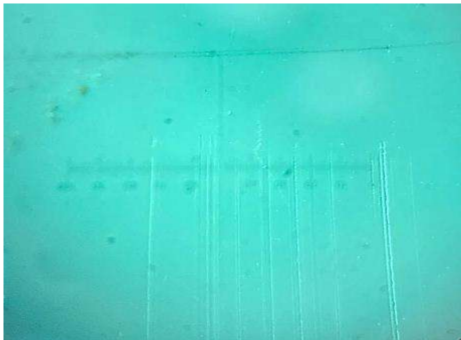
Рис. 7. Применение направленного источника освещения и синего светофильтра для контрастирования следа скольжения на полимерной поверхности (слева) и фрагмент динамического следа скольжения на полимерной поверхности исследуемого объекта в поле зрения микроскопа. МСП – ТМ в отраженном косопадающем при увеличении объектива микроскопа 0,65x с применением синего светофильтра
