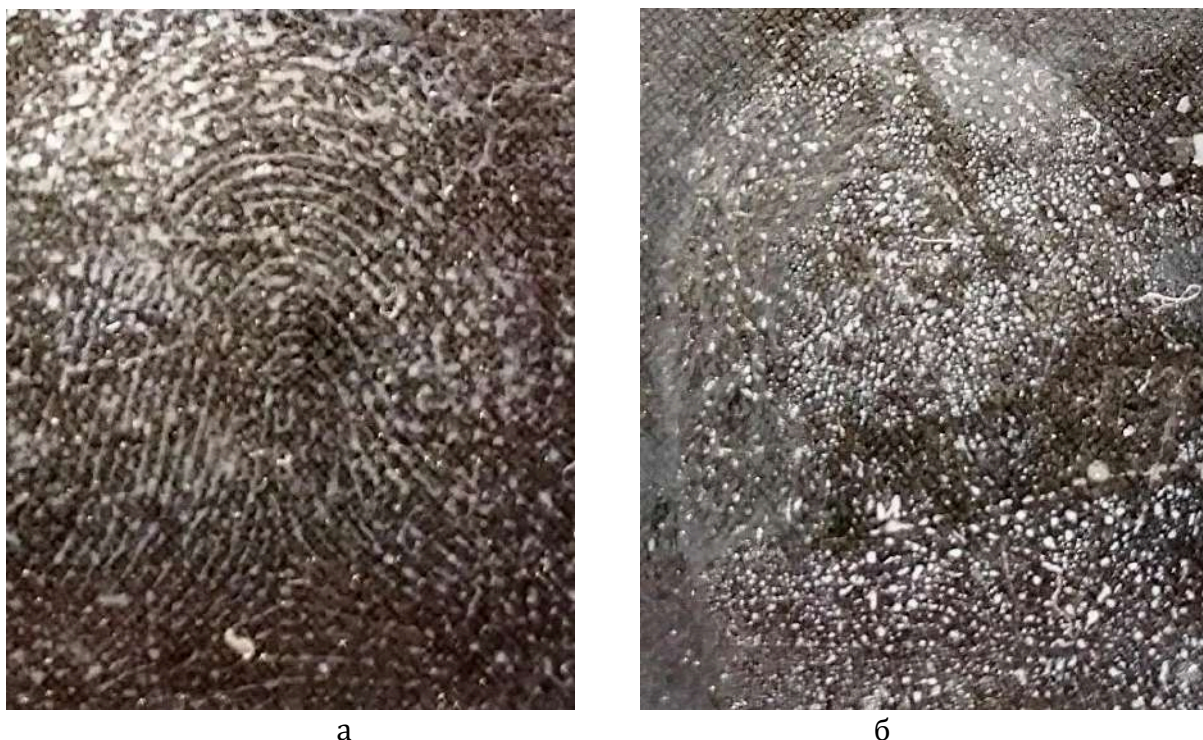
Рис. 4. Полимеризация паров цианакрилата на следах пальцев рук после нахождения при температуре от -7^{\circ}\text{C} до -20^{\circ}\text{C} свыше 3 месяцев и оттаивания:
