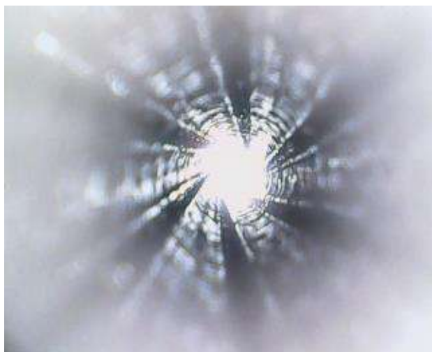
Рис. 23. Нарезы в канале 1-ой трубки
