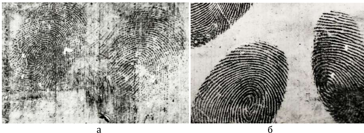
Рис. 11. Следы рук, образованные на охлажденном оцинкованном металле, пребывавшие в течение 1 суток при температуре от -11 до -18 °С и выявленные вне помещения при температуре -12 °С: а – дактилоскопическим порошком «Сажка»; б – смесью № 2 (табл. 4)
