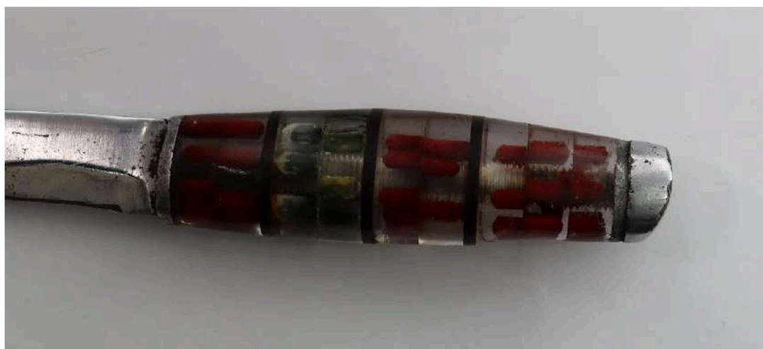
Рис. 7. Рукоять самодельного ножа, изготовленная из полиметилметакрилата
