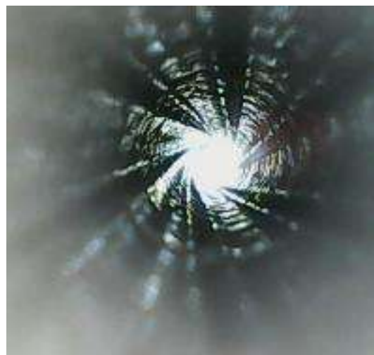
Рис. 24. Нарезы в канале 2-ой трубки
